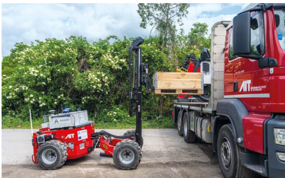
Der Mitnahmestapler lässt sich in einem LKW mitführen. Er übernimmt eigenständig das Be- und Entladen von Paletten und macht damit ein flexibles Handling von Gütern im Freien möglich.
