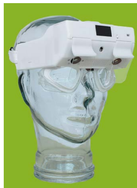
Die Diagnostik-Brille Merlin von Zeisberg ermöglicht erstmals kabellose Video-Kopf-Impulstests, unabhängig von einem externen PC.
