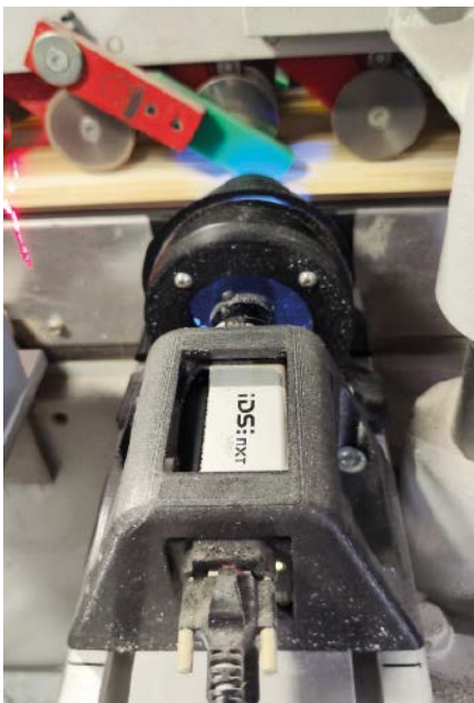
Scheucher nutzt die Inferenzkamera-Komplettlösung für KI-Anwendungen in der industriellen Bildverarbeitung von IDS - die IDS-NXT-Rio: Die Inferenzkameras erkennen mittels neuronaler Netze fehlerhafte Verklebungen.
