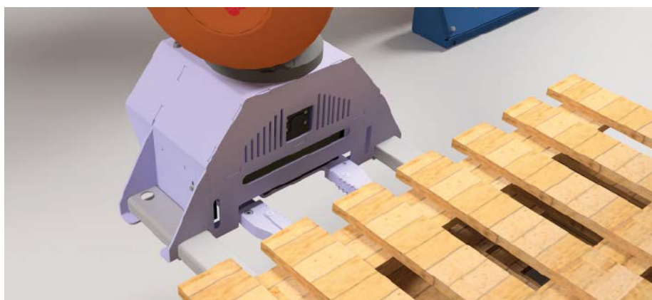
Die Kamera befindet sich im Zentrum der Greiferstruktur am Kopf des Roboters. Dort vermisst sie die jeweilige Palette.
