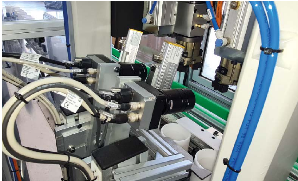
Eine Zeilenkamera tastet die Flasche ab und nimmt so ein zweidimensionales Bild ihrer gekrümmten Oberfläche auf.
