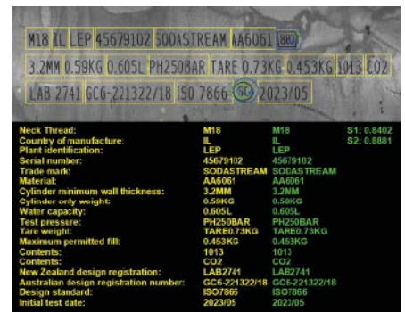
Halcons Deep OCR basiert auf Deep-Learning-Algorithmen und kann Zeichen unabhängig von ihrer Ausrichtung, Schriftart und Polarität zu lokalisieren.
