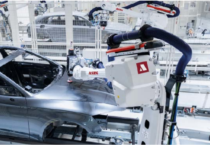
Erkannte Defekte im Lack kann Micro-Epsilon zusammen mit den Partnerfirmen ASIS und Virtek Vision automatisch abarbeiten. Das geschieht über weitere Roboter mit aktiver Kraftregelung, die mit jeweils einem Schleif- und Polierkopf in Dual-Montage ausgestattet sind.
