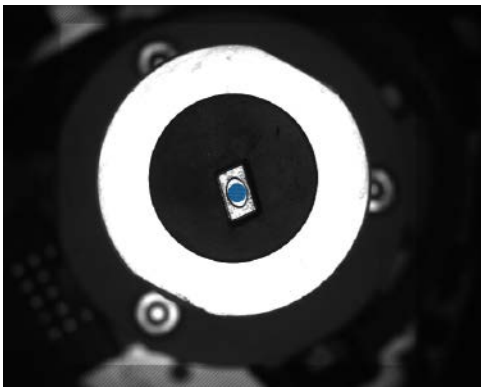
Erkennen der Bauteilmitte von unten zur Positionskorrektur vor dem Aufsetzen auf die Pinpalette
