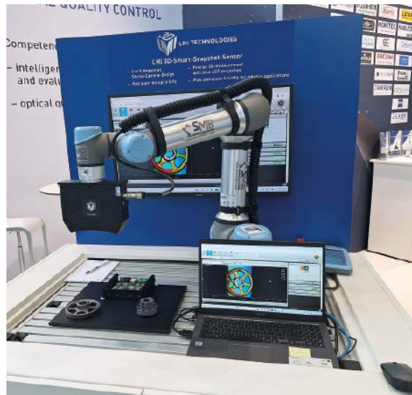
Eine Messedemo mit dem 3D-Sensor LMI Gocator 3210 am Arm eines kollaborativen Roboters von Universal Robots
