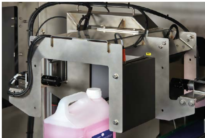
Auf einem Kanister wird der Verschluss, das Siegel und das Etikett inspiziert.
