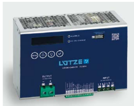
Das primär getaktete Compact-Netzgerät von Lütze arbeitet mit DC 24 V und 2.400 W.
