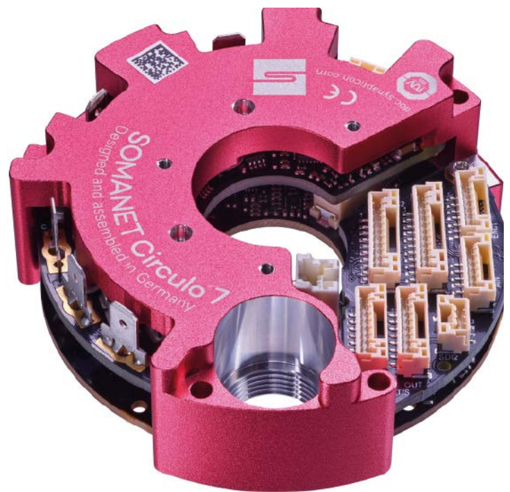
Somanet Circulo gilt als das weltweit erste Integrated Motion Device: eine komplette Servo-Lösung für Roboter und intelligente Aktoren.
