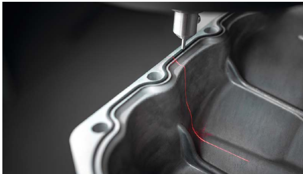
Für den steigenden Bedarf an hochwertigen Lösungen in der Batteriefertigung eignet sich der Spintop G2 ebenfalls. Dazu gehören Anwendungen wie die Kontrolle der Abdichtung von Batteriegehäusen
