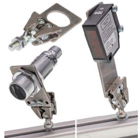
Universalhalter mit multifunktionalem Grundmodul plus Kugelgelenk für die Befestigung an einem Industrieprofil
