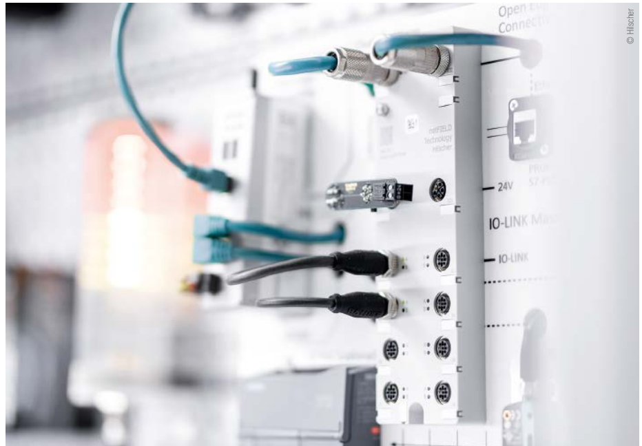
Die beiden Edge-IO-Link-Master SensorEdge Field und SensorEdge können direkt in Ethernet-basierte IT-Infrastrukturen eingebunden werden.
