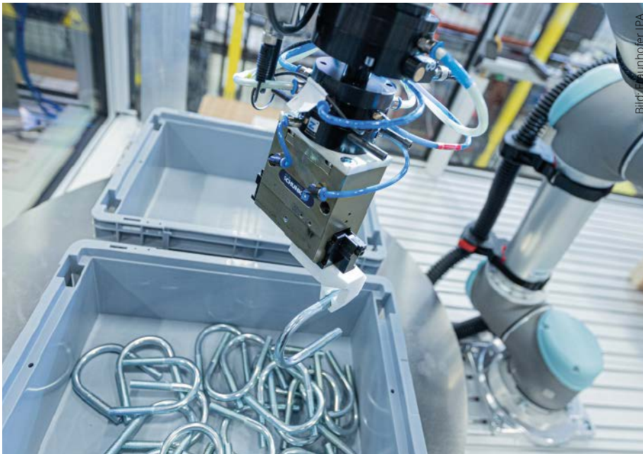
Auf der Automatica 2022 zeigte das Fraunhofer IPA eine KI-gestützte Bin-Picking-Lösung, die verhakete Bauteile erkannte und selbstständig vereinzelt.
