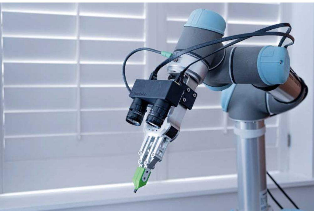
Das Bin-Picking-System besteht aus einem Modul für Roboterarme, einer Recheneinheit mit vorinstallierter Software sowie einem Kameramodul.
