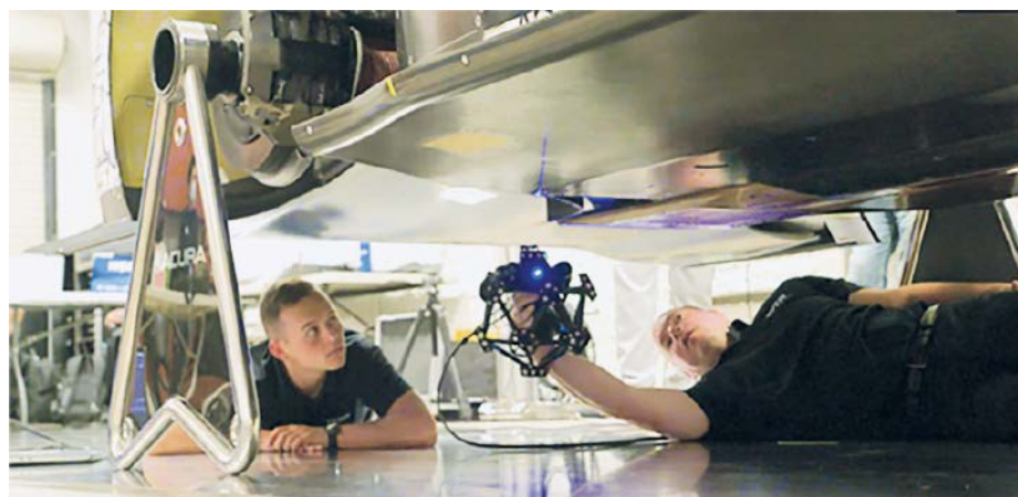
WTR-Andretti-Ingenieure scannen den Unterboden des Rennwagens Konica Minolta Acura ARX-06 mit dem Creafom Metrascan 3D.
