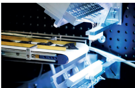
Prototypischer Terahertz-Sensor für die Sortierung von Kunststoffabfällen
