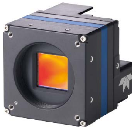
Die Falcon4-CLHS-Flächenkameras von Teledyne bieten eine hohe Auflösung und Hochgeschwindigkeitsübertragung mit einer Camera-Link-HS-Schnittstelle.
