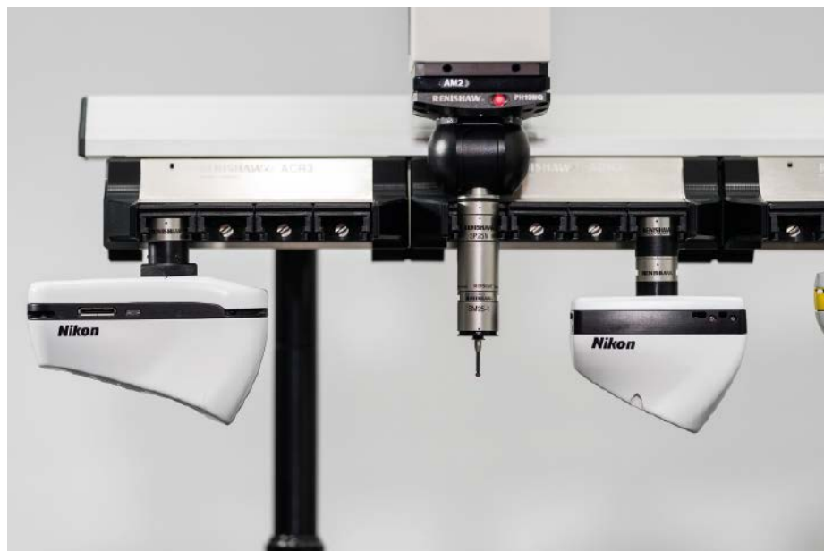
Der Betrieb lässt sich mit dem taktilen Antasten für Multisensor-Messroutinen auf einem KMG kombinieren.
