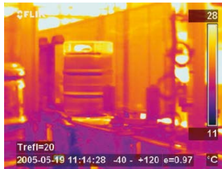
Bei der Reinigung von Bierfässern unterstützen Wärmebildkameras, indem sie die Reinigungslösung sichtbar machen.
