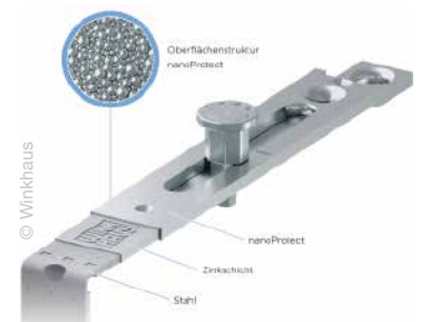
Erfolgreiche Abwehr von Korrosionsangriffen durch die Standardbeschichtung Nanoprotect
