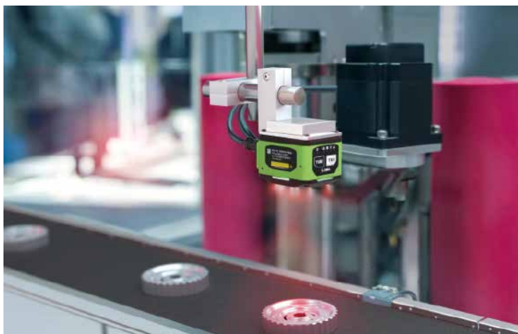
Deep Learning OCR vereinfacht die Qualitätskontrolle von Bauteilen.
