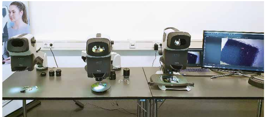
Die Modelle der dritten Mantis-Generation (v.l.): Iota, Ergo und Pixo. Letzteres verfügt über ein digitales Bildgebungssystem, mit dem hochauflösende Bilder einfach erfasst, geprüft und geteilt werden können.
