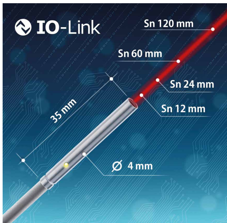
Die optischen Miniatur Sensoren bieten vorkalibrierte Erfassungsbereiche von 12, 24, 60 oder 120 mm in der Lichttasterausführung.
