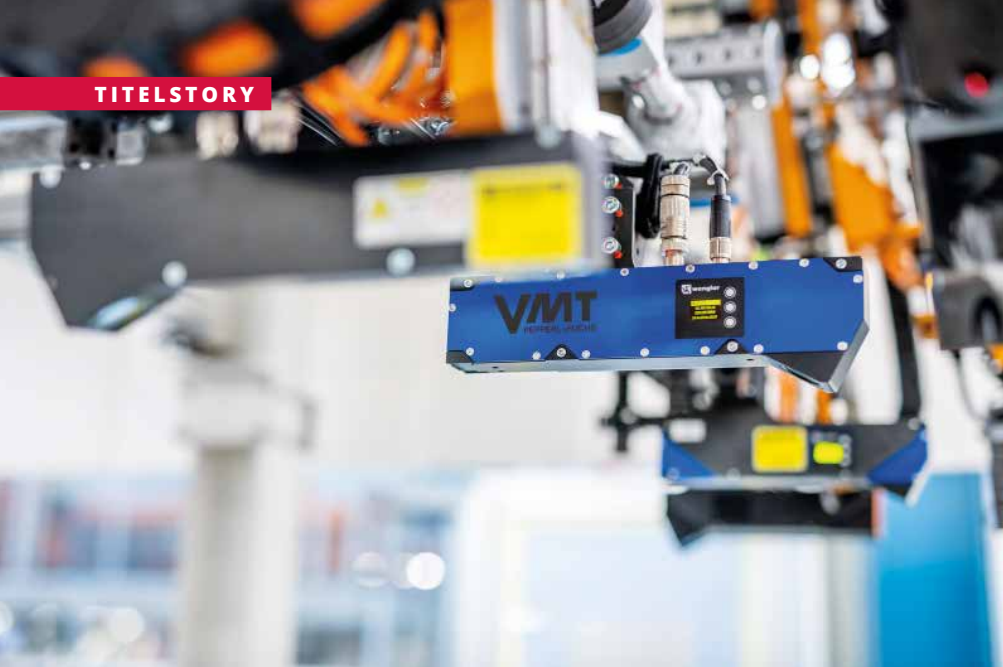
Paarweise gegenläufig angeordnete Laser-Triangulationsensoren ermöglichen hinterschneidungsfreie Scans.
