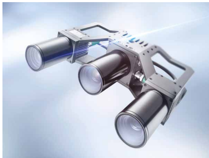
Die 3D-Kamera BVS 3D-RV1 mit integriertem Musterprojektor von Matrix Vision erreicht mit ihren 12-MPixel-Sensoren eine hohe Erfassungsgenauigkeit, weshalb sie sich etwa für Binpicking-Anwendungen eignet.
