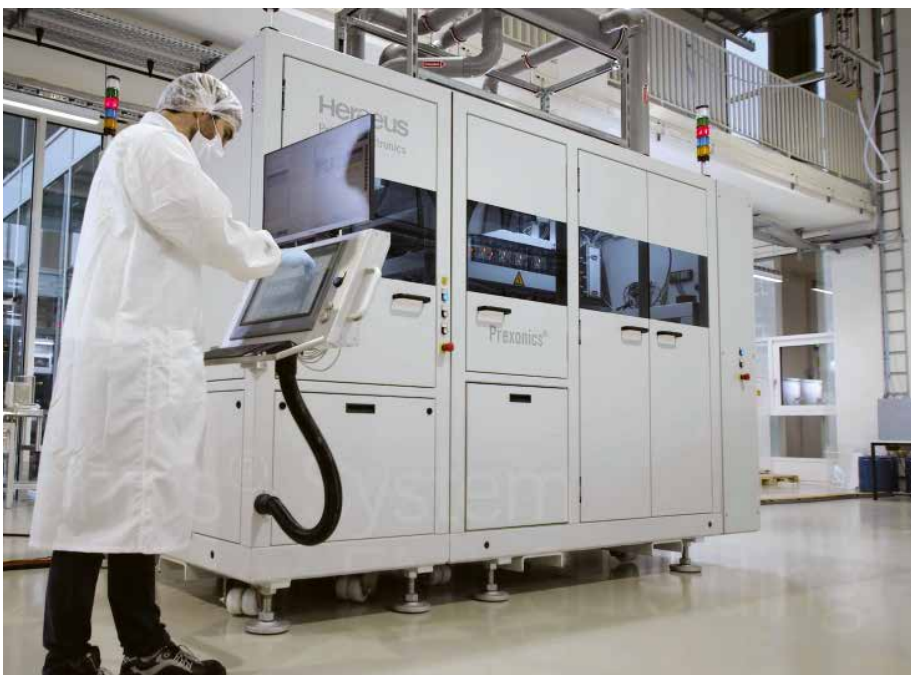
Die Prexonics-Anlagen von Heraeus Printed Electronics ermöglichen eine sichere und schnelle EMV-Abschirmung von 5G-Bauteilen.
