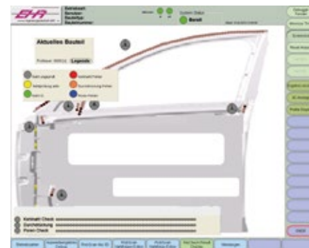
Tivis mit anwenderspezifischer Bedienoberfläche. Sie zeigt: die ortsbezogene und klassifizierte Fehlerdarstellung der Schweißnaht nach Ende der Prüfung
