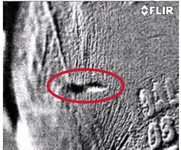
Abb. 3: Mit der GF306 lassen sich mit SF 6 -Gas befüllte Isolatoren aus sicherer Entfernung untersuchen.
