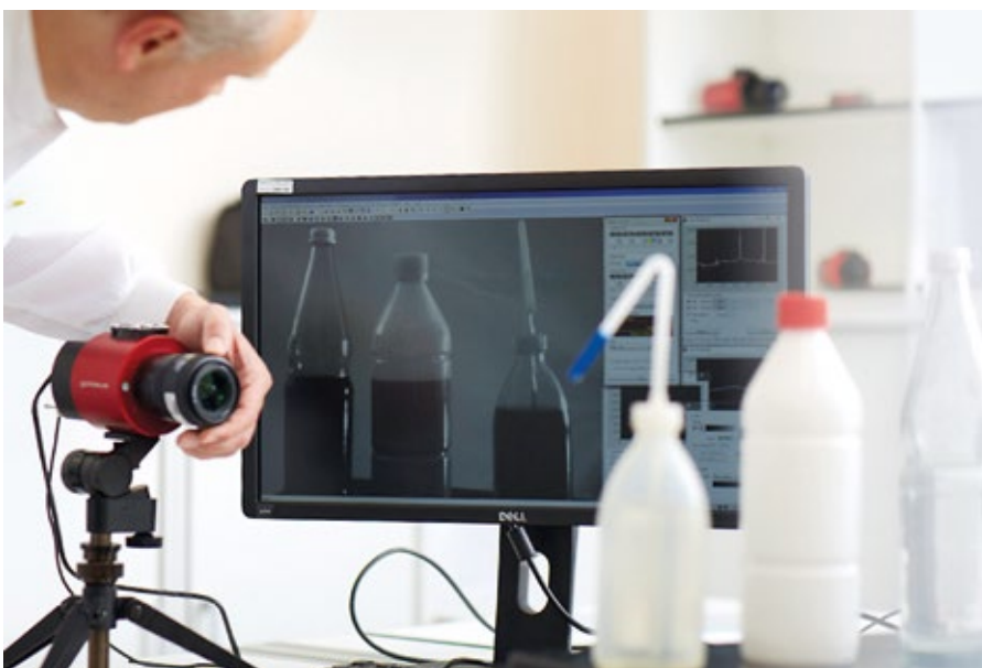
Mit Infrarotkameras lässt sich die Füllmenge von Behältern hervorheben.
