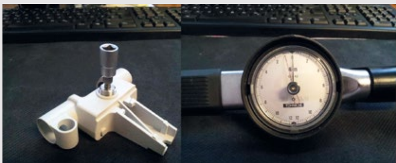
Abb. 2a: Ein Kunde reklamierte das Gewinde in einem Spritzgießteil, weil sich der dazugehörige Metallbolzen, ein Normteil, zu schwer einschrauben ließ. Das gemessene Drehmoment war zu hoch. In solch einem Fall besteht die Gefahr, dass sich der Kunststoff deformiert.
