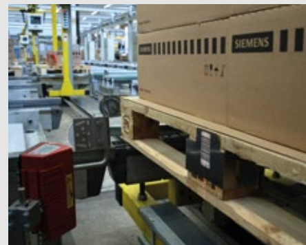
Barcodeleser mit Profinet ermöglichen Wegentscheidungen in Echtzeit.
