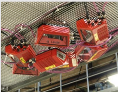
Das individuell gestaltete Omniportal mit trickreicher Anordnung von sieben Barcode-Scannern deckt die gesamte Breite einer Förderstrecke ab.
