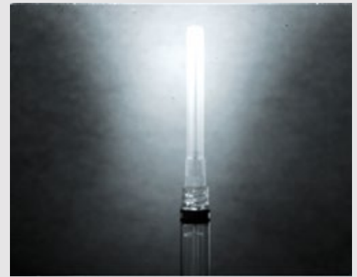
Infrarotkameras prüfen die Anwesenheit der Nadel bei Injektionsspritzen durch die Schutzkappe hindurch.
