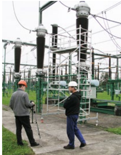
Abb. 3: Mit der GF306 lassen sich mit SF 6 -Gas befüllte Isolatoren aus sicherer Entfernung untersuchen.
