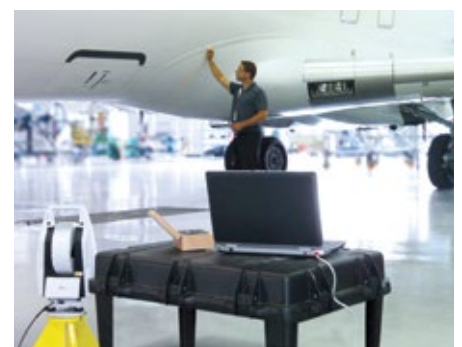
Im Modus „geführtes Messen“ gibt die Software die Messung der einzelnen Referenzpunkte vor, die der Techniker mit dem Reflektor aufnimmt.
