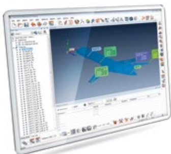
CAD Daten des jeweiligen Flugzeugtyps mit Referenzpunkten und den gemessenen Werten
