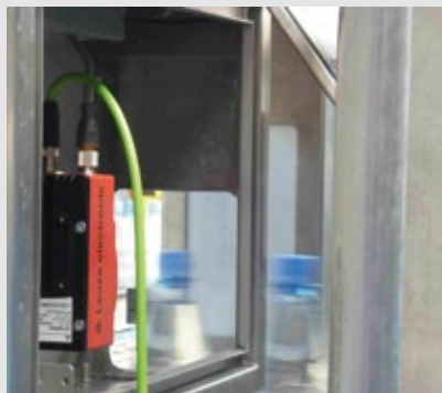
Verschlussschleppkontrolle: Mit gegenüberliegender Durchlichtquelle schafft die Kamera LSIS 412i bei Aqua Römer eine Erkennungsleistung von 99,8 %.
