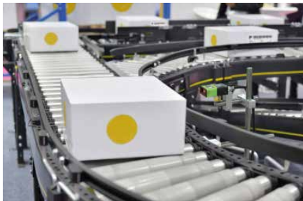
Auch die An- oder Abwesenheit von Etiketten prüft eine OCR-Lösung in Kombination mit Deep Learning automatisch.
