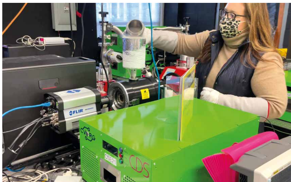
CDS testet eines seiner Projektorsysteme mit einer FLIR SC8200. Dieses spezielle Projektorsystem verwendet Flüssigstickstoff, um optimale Leistungen zu erzielen.
