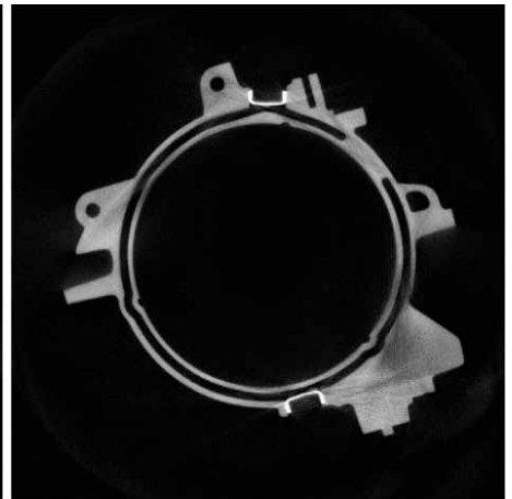
Röntgenaufnahme eines Statorgehäuses: Links die nicht-korrigierte, 20-minütige axiale CT-Messung in Stop & Go; rechts die streustrahlkorrigierte 42-sekündige Flyby-Quickscan-Messung
