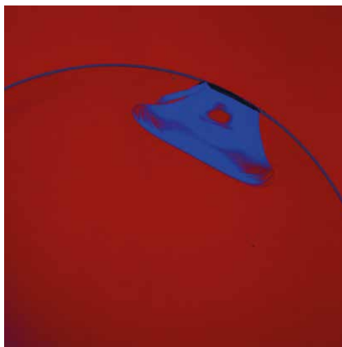
Einsatz eines Lichtfeld-Displays zur problemspezifischen Beleuchtung in der industriellen Sichtprüfung. Zu sehen sind Rohbilder (ohne Bildverarbeitung) einer Linse mit Defekt. Links: klassische Hellfeldbeleuchtung. Rechts: Lichtfeldbeleuchtung.
