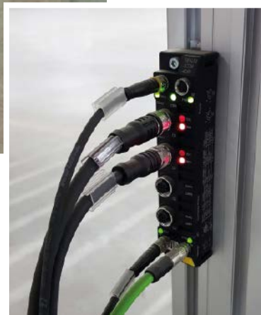
Turcks TBEN-S Multi-protokoll-I/O-Module sichern die Kommunikation zwischen den PTL110 und dem WMS.
