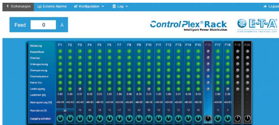
Graphische Benutzeroberfläche des ControlPlex Rack zur Überwachung oder Steuerung des Stromverteilungssystems
