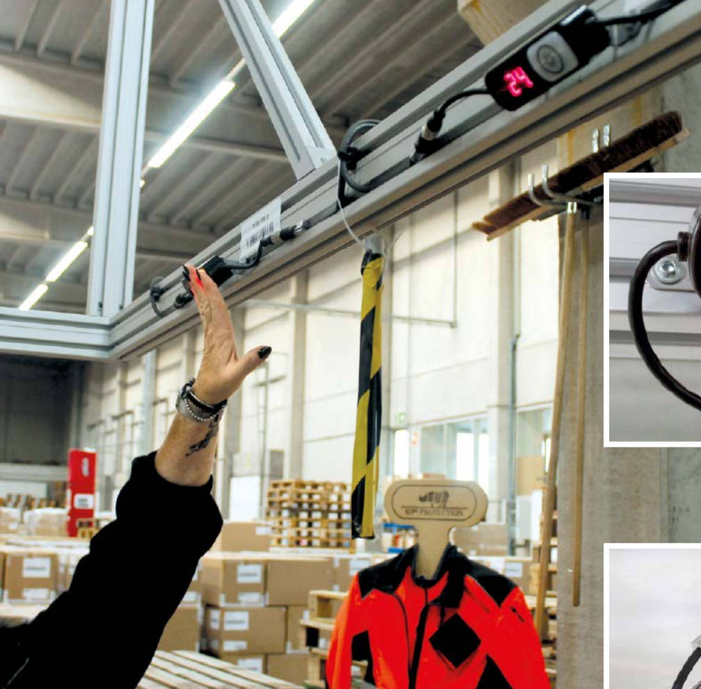
Die Mitarbeiter stellen den Karton auf die angezeigte Palette und quittieren die Aktion über den Touch-Button des PTL110.
