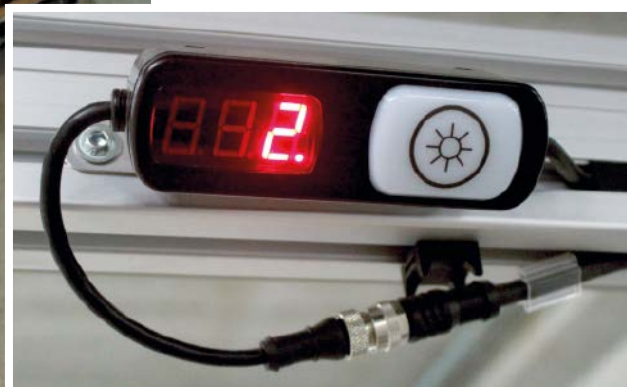
Die Mitarbeiter stellen den Karton auf die angezeigte Palette und quittieren die Aktion über den Touch-Button des PTL110.
