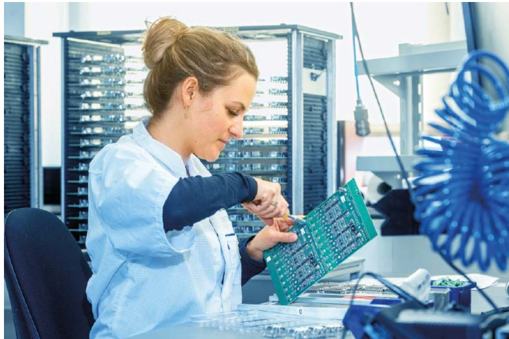
Bei der Herstellung von Frequenzumrichtern erfolgen einige Arbeitsschritte nach wie vor in Handarbeit.
