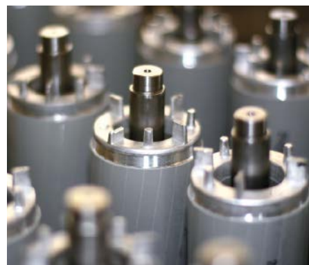
Die Kurzschlussläufer werden bei Groschopp individuell auf Kundenanforderungen angepasst.
