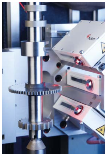
Die alpha.si-Messgeräte wurden für die Inline-Messung von Wellen und anderen Rotationsteilen entwickelt.
