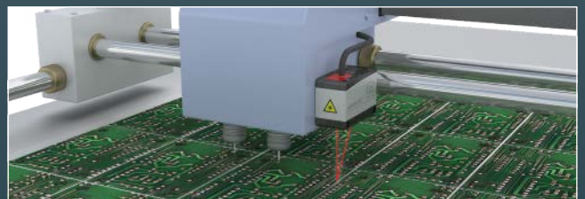
Mikrometeregenaue Ausrichtung in Bestückungsautomaten
