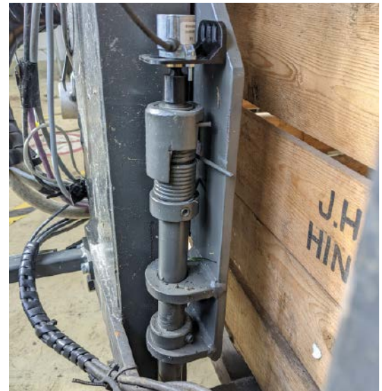
Die Position der Kistenaufnehmer, der sogenannten Flipper, wird über den Miniaturdrehgeber AH25S ermittelt (der Drehgeber befindet sich am oberen Ende der Konstruktion).
