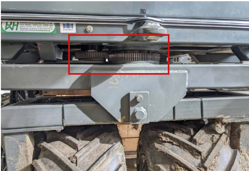
Wichtiges Detail an der Lenkung: Der Multiturn-Drehgeber WV5800M erfasst den Lenkwinkel, damit das Fahrzeug seinen definierten Pfad sicher umsetzen kann.
