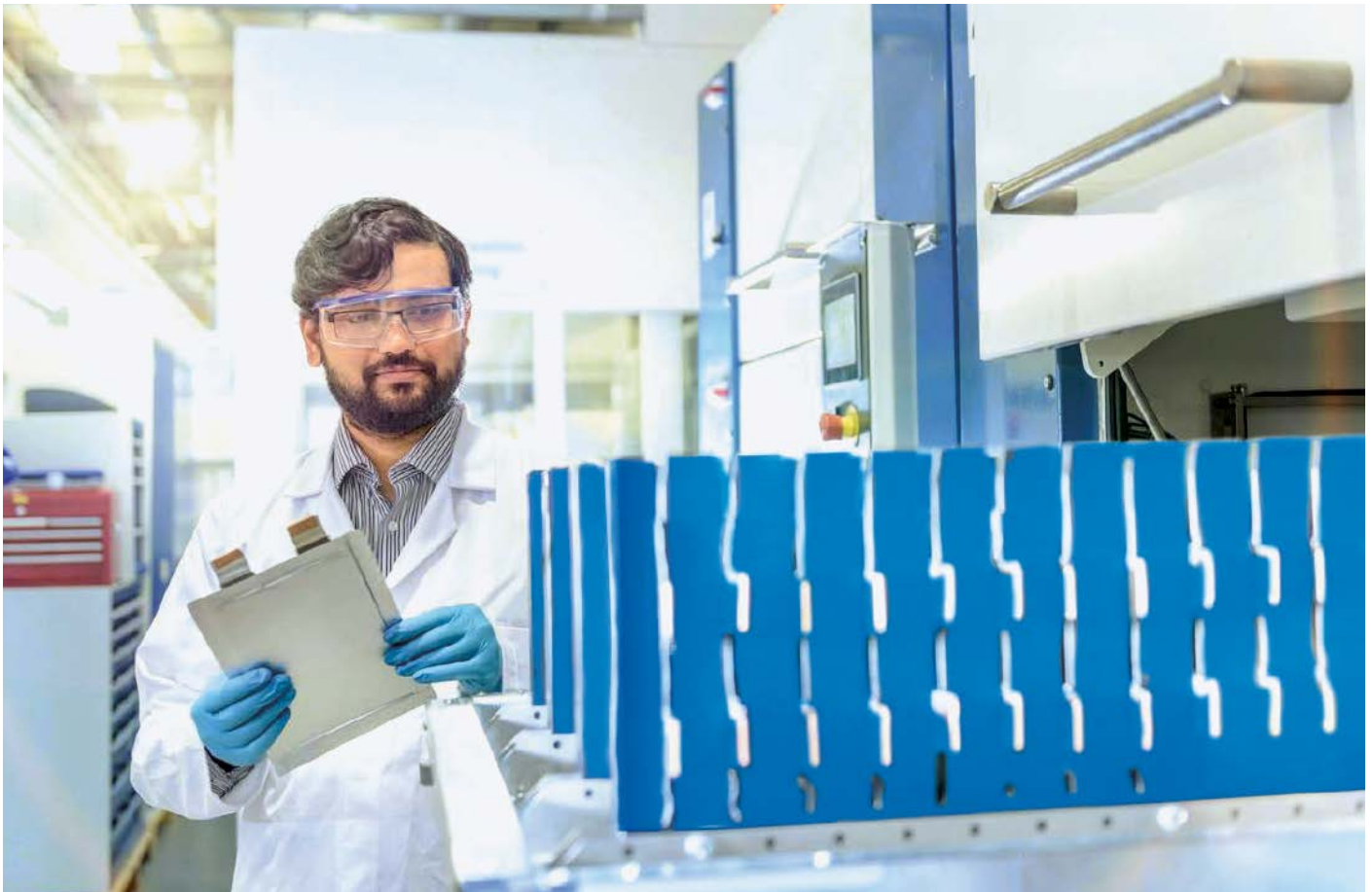
Das Gehäuse wird mit einem hellblauen UV-Lack beschichtet. Da die Beschichtungsdicke eine funktionskritische Kenngröße ist, wird diese präzise und dokumentationsicher gemessen.
