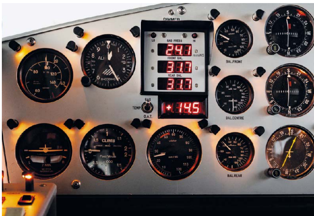
Vorteil von digitalen Anzeigen: Wenn minimale Druckunterschiede die Fluglage des Luftschiffs beeinflussen, kommt es auf die Nachkommastellen der Druckanzeige an, die direkt im Sichtfeld des Piloten verbaut ist.
