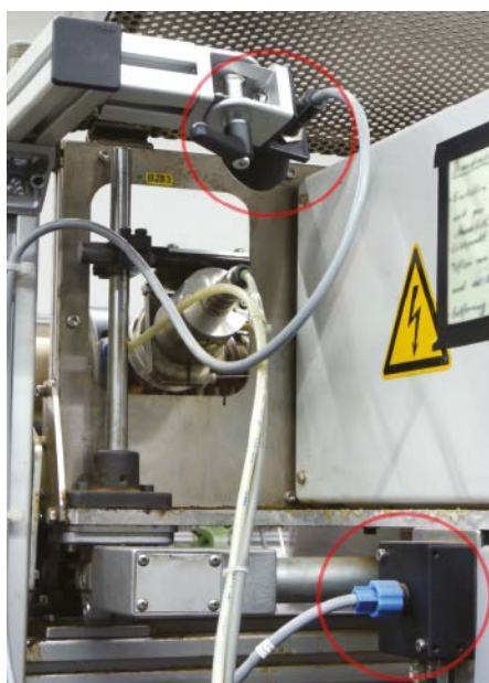
Einsatz eines High-End-Kontrasttasters (rechts unten) in einer Applikation zur Detektion von Rauch an einer Induktionsspule zur Erwärmung von Aluminium und Kraftpapier, aus denen flexible Rohre für die Klimatechnik in Caravane gefertigt werden. Die Lösung dient als Frühwarnsystem, um Brände in der Induktionsspule zu vermeiden. Die über den Lichtleiter verbundene Optik (oben) ist an der Austrittsöffnung der Induktionsspule installiert.
