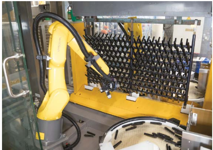
Die Bestückung des Galvanikgestells funktioniert vollautomatisch: Der Roboter greift je ein Teil aus dem Vereinzelungskarussell (rechts unten) und platziert es an einem der 250 Haken.
