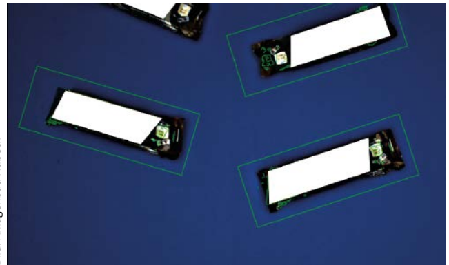
Das Machine-Vision-System dient als Auge für den Roboter. So lokalisiert das Merlic Tool „Mit Matching lokalisieren“ die Schokoriegel auf dem Band präzise, robust und schnell – unabhängig von deren Ausrichtung.
