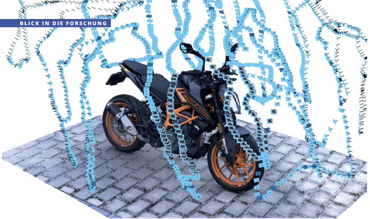
Motorradmodell mit Scanner-Trajektorie (blaue Linie). Diese zeigt die verschiedenen Kamerapositionen während der Bildaufnahme beim Erfassen des Motorrades, ein sehr komplexes Messobjekt mit vielen sicherheitsrelevanten Details, zum Beispiel den Schrauben.
