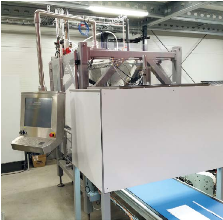
Bedient wird das System mittels Industrie-PC mit Touchscreen. Das Robotergestell, die Einhausung sowie das Ein- und Auslaufband hat Anlagenbau Habeck in Eigenregie konzipiert und installiert. Der Bildeinzug schließlich stammt von einer GigE-Vision-Kamera von Imaging Source.
