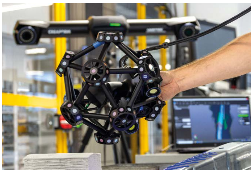
3D-Scansysteme von Creaform werden heute hauptsächlich im Reverse Engineering oder in der Qualitätskontrolle eingesetzt.
