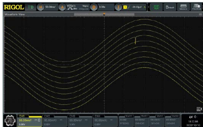
Abb. 5: Schnelle Glitchanalyse mit Ultra Acquire (hier: Wasserfalldarstellung)
