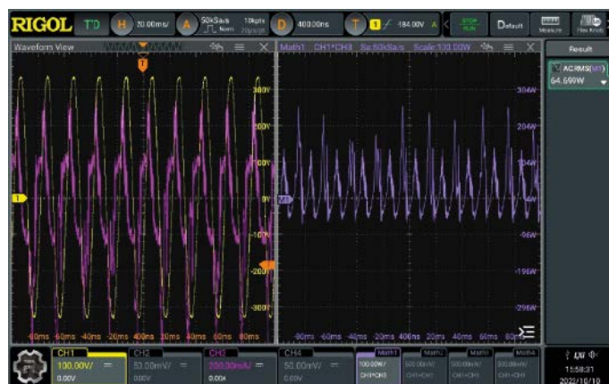
Abb. 2: Messung eines Schaltnetzteils mit Last, Spannung: gelb, Strom: pink
