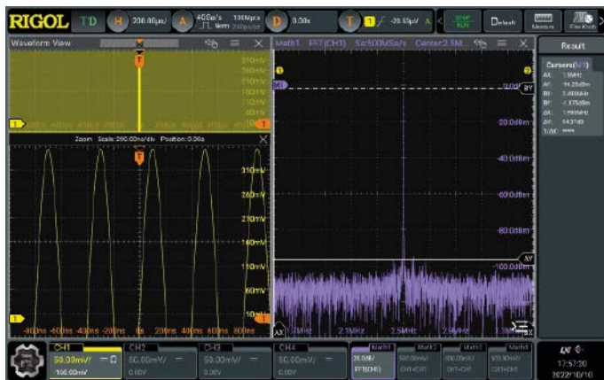
Abb. 4: FFT mit einem sehr hohen störungsfreien Dynamikbereich
