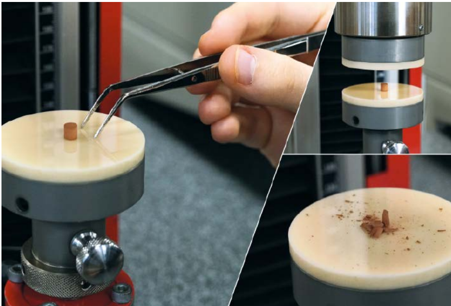
Kombination mit Detailaufnahmen der Regolith-Probe im Druckversuch
