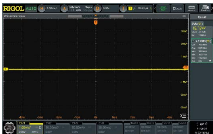
Abb. 1: Niedriges Rauschverhalten unter 18 \mu\text{Vrms}
