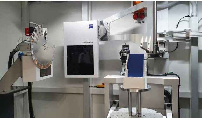
Der Drehteller im Computertomografen Zeiss Metrotom ermöglicht es, ein dreidimensionalen CT-Scan zu erstellen, um so beispielsweise eine Batteriezelle (blaues Teil in der Bildmitte) zu prüfen.
