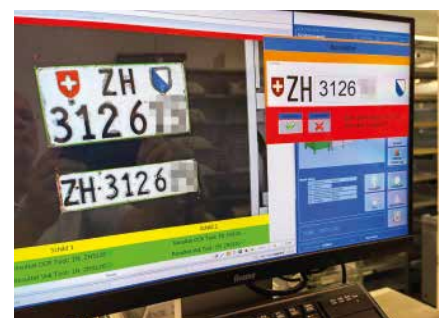
Wenn bei schlecht lesbaren Schildern beide Erkennungsprogramme unterschiedliche Ergebnisse liefern, muss der Bediener eingreifen und das Ergebnis manuell korrigieren.
