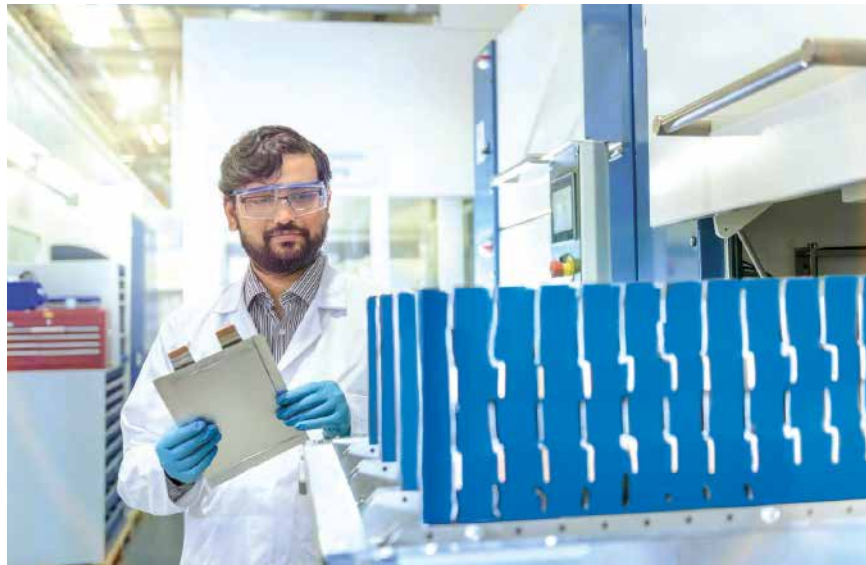
Das Gehäuse wird mit einem hellblauen UV-Lack beschichtet. Da die Beschichtungsdicke eine funktionskritische Kenngröße ist, wird diese präzise und dokumentations-sicher gemessen.
