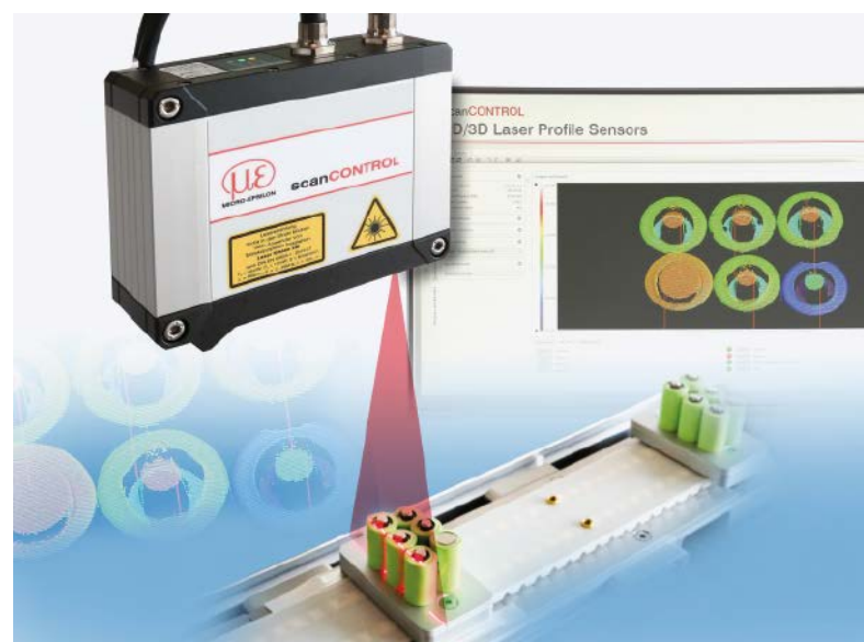
Auch bei der Ausrichtung der Rundzellen im Montageprozess von Batterien sind Laserscanner erforderlich. Hierbei spielen die korrekte Ausrichtung sowie die Höhe der einzelnen Zellen zueinander eine wichtige Rolle.
