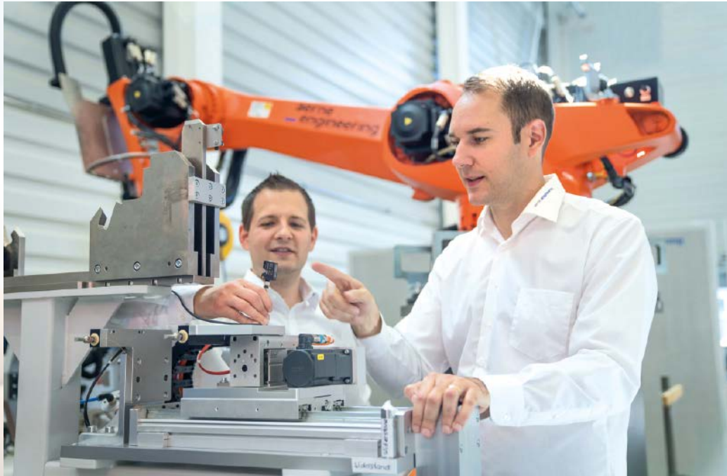
Patrick Kurer (r.) zeigt Baumer-Berater Heinz Buchegger an der Übergabestation, warum sich der IO-Link-Sensor OT300 für diese Applikation eignet.
