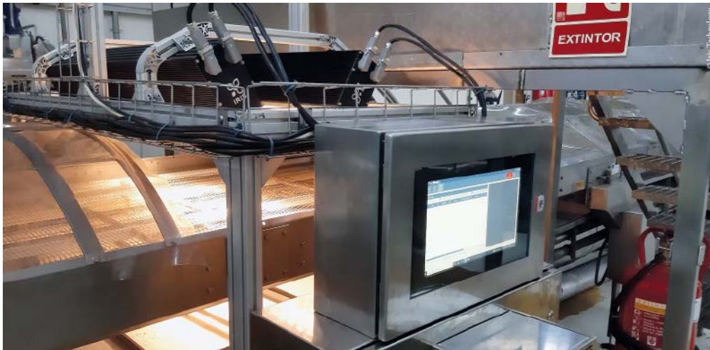
Das Visum-HIS-Inspektionssystem von Iris Technologies ist seit mehr als einem halben Jahr in der Produktionslinie der Bäckerei im Einsatz. Dieses überwacht seitdem stetig den Fettgehalt der Kekse sowie weitere Parameter.
