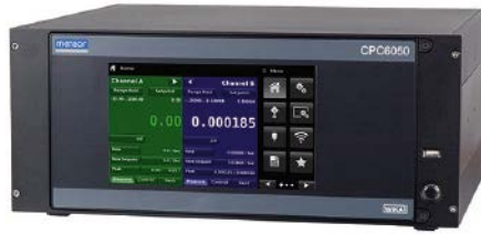
Herzstück der Kalibrierstände bilden Druckcontroller der CPC-Reihe von Wika. Diese Geräte liefern Genauigkeiten von bis zu 0,008% IS 33.
