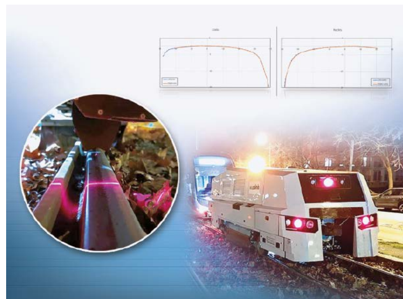
Beim High-Speed-Grinding-Verfahren werden Schienen bei Fahrtgeschwindigkeiten von bis zu 80 km/h geschliffen.
