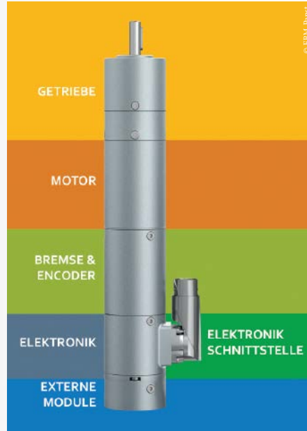
Aus dem modularen Antriebssystem lassen sich Lösungen flexibel für konkrete Aufgabenstellungen kombinieren – inklusive Getriebe, Geber und Bremsen. Insgesamt sind mehrere tausend Varianten möglich.
