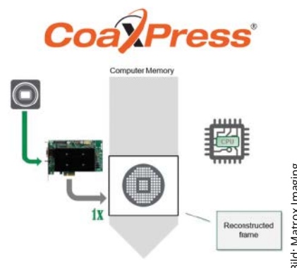
Ablauf der Bildrekonstruktion im Vergleich: Im Gegensatz zu Grabber-basierten Lösungen ist die CPU bei GigE-Vision-Systemen immer in die Bildakquisition involviert.
