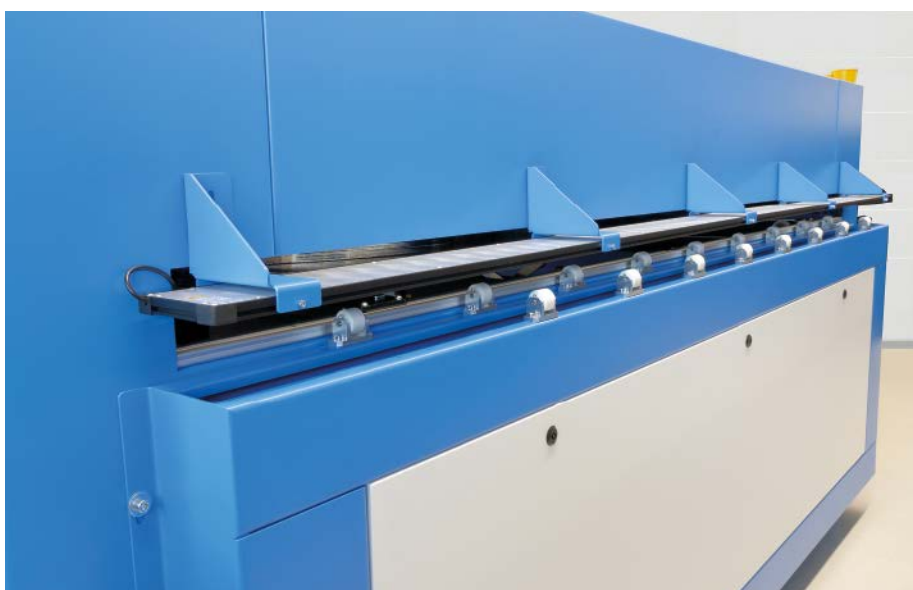
Die 2,5 m lange Beleuchtung aus der MBJ-Imaging-Flex-Serie am Inspektionsgerät Solarmodule EL-Quickline. Es inspiziert die Solarmodule in der Bewegung während des Einförderns. Innerhalb der Maschine findet dann die Elektrolumineszenz-Prüfung statt.
