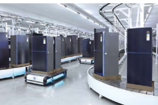
Das fahrerlose Transportsystem Multi-Sensing Autonomous Vehicle (MAV) lädt und transportiert Waren autonom. Durch die integrierten Sensoren sind dazu keine zusätzlichen Peripheriegeräte nötig.
