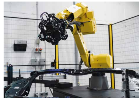
▼ Robotergeführter optischer KMG-Scanner bei der Qualitätskontrolle eines Fahrgestells
