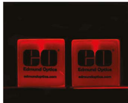
Mittleres Bild: Durch den Öffnungswinkel des Festbrennweitenobjektivs wird der rechte Würfel kleiner abgebildet als der gleichgroße Würfel, der sich näher am Prüfsystem befindet. Rechtes Bild: Die gleiche Szene aufgenommen mit einem telezentrischen Objektiv. Jetzt sind beide Würfel gleich groß.
