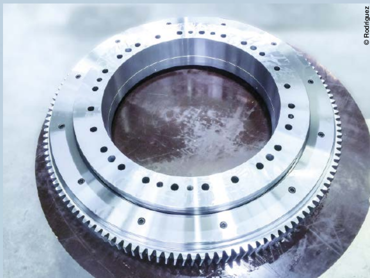
Bei einem rund 40 Jahre alten, vertikalen CNC-Dreh-Fräszentrum übernimmt eine Kreuzrollendrehverbindung von Rodriguez die Lagerung des Drehtisches.
