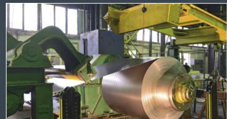
Erfassung von Coildurchmessern
