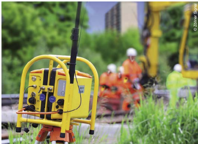
Zöllner Signal setzt in ihrem Mobilem Funkwarnsystem MFW ein Polyamid-Sondergehäuse von Rose Systemtechnik ein.
