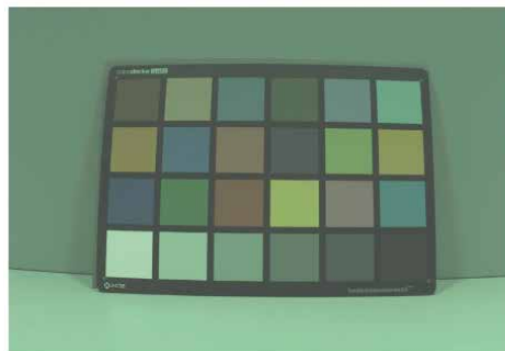
Links: Aufnahme vor der Kalibrierung des Image Signal Processors (RAW). Rechts: Aufnahme nach der Farbkorrektur und dem Weißabgleich.
