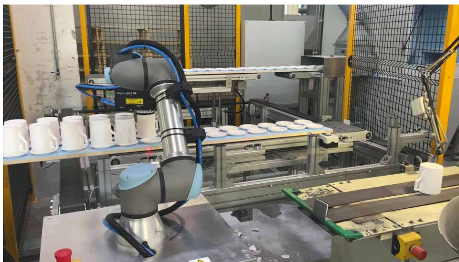
Der 3D-Profilesensor Matrox Altiz ist am Ende des Cobotarms montiert und liefert hochauflösende Scans der weißen Teetassen aus Porzellan.
