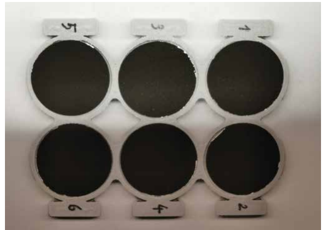
Elektrodenstanzlinge von Li-Ionen-Batterien: Stanzlinge dienen typischerweise der Kalibrierung und Qualitätsprüfung. Ihre Schichtdicke wird meist als konstant angenommen.
