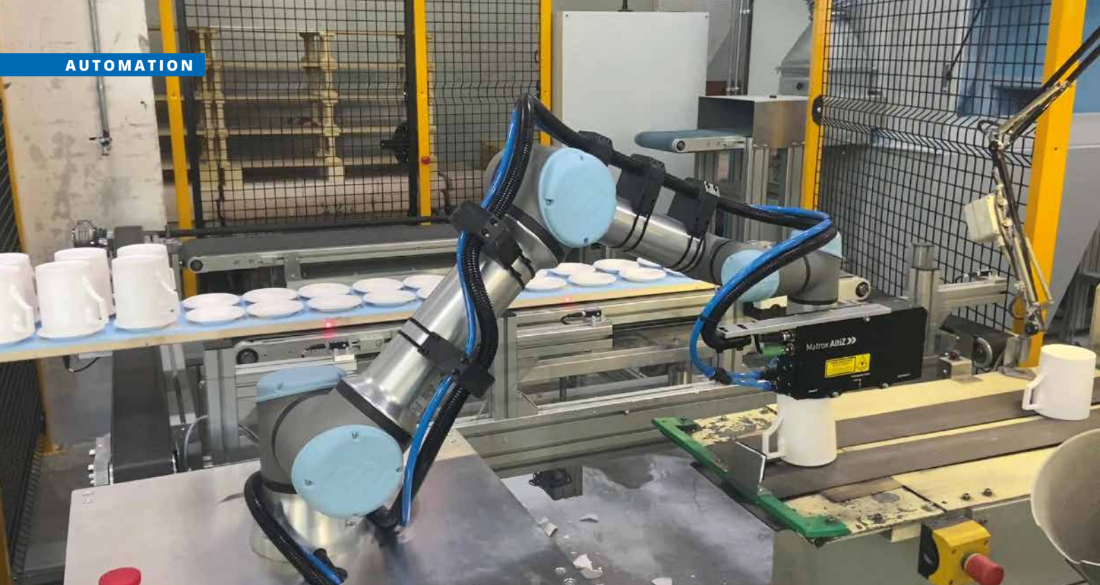
Die Informationen zu Rotationswinkel und Position der Tassen erhält der Cobot von der Software Matrox Design Assistant X, woraufhin der Roboter die Tassen greift und platziert.
