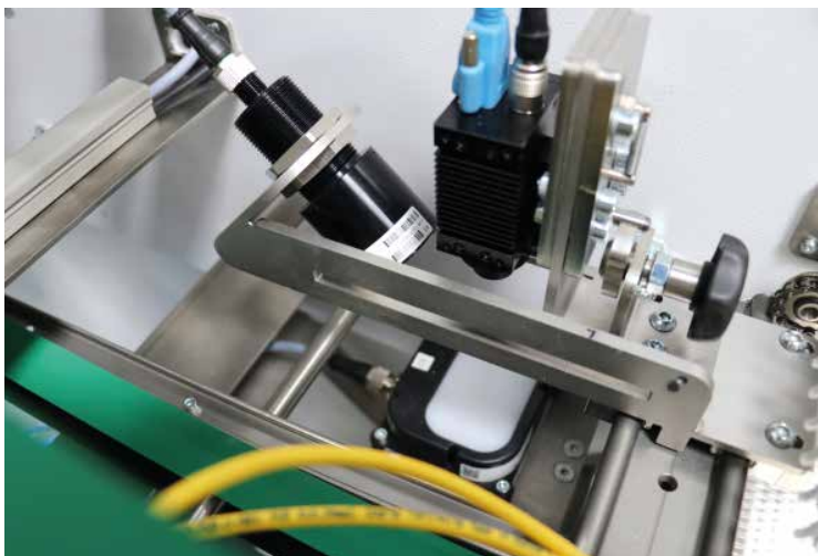
Die beiden Kameras vermessen die Schneidmarkenposition relativ zur Papieraußenkante.
