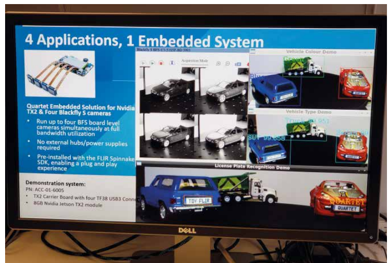
Das Testsystem (ganz links) und die vier Anwendungsbeispiele in der Übersicht: Frontscheibeneinblick mittels Polarisation (oben links), Fahrzeug-Farbklassifikation (oben rechts), Fahrzeugtyp-Kategorisierung (Mitte rechts) und Kennzeichenerkennung (unten), die letzten drei jeweils mittels Deep Learning.
