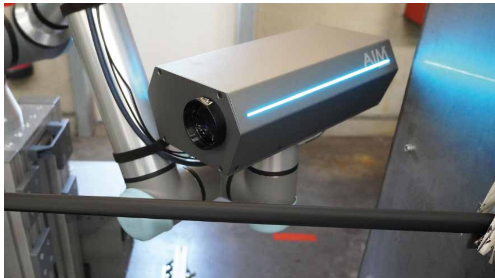
Inline-Messung von Gleitlack auf Gummi. Durch den hohen thermooptischen Kontrast lässt sich die Schichtdicke sehr gut photothermisch messen.
