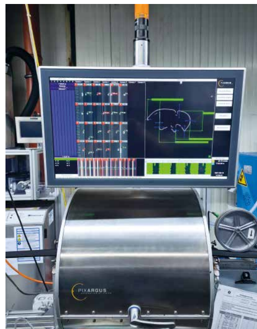
Qualitätsdaten im Blick: Auf dem Monitor ist Oberflächenbewertung für Laufmeter 1125 zu sehen. Sechs der acht Systemkameras lieferten die Daten dazu.
