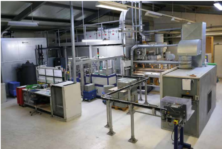
Die Pulverbeschichtungsanlage lackiert 150 PDC-Sensoren (PDC: Park Distance Control) pro Minute für die Automobilindustrie.
