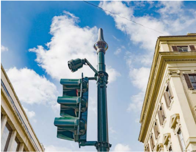
Smart Tips der Genius-Version, bestehend aus zwei Sensoren, wurden im Zentrum von Rom installiert, wo sie die umliegenden Straßen und Parkplätze überwachen.
