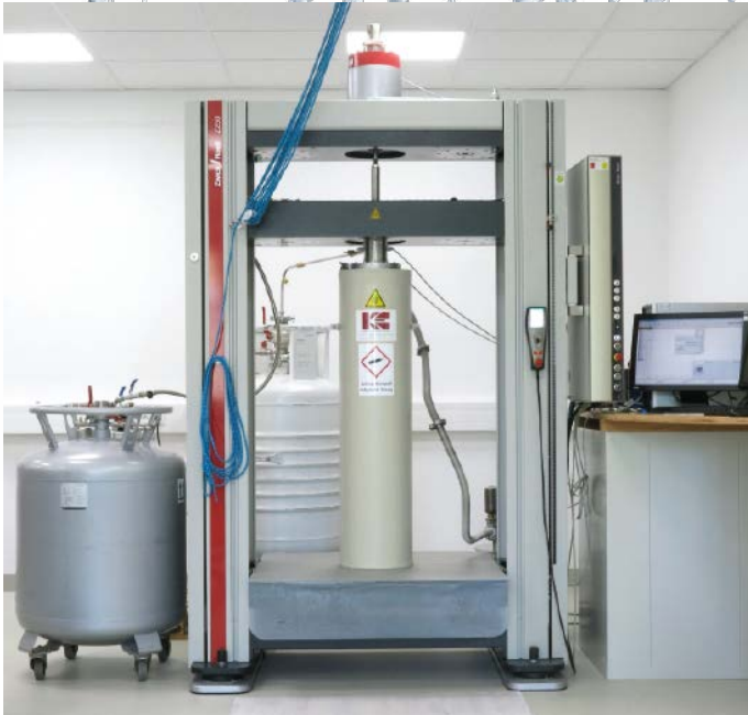
Tiefemperaturtest mit der ZwickRoell AllroundLine Z250 SW bei 4 Kelvin.
