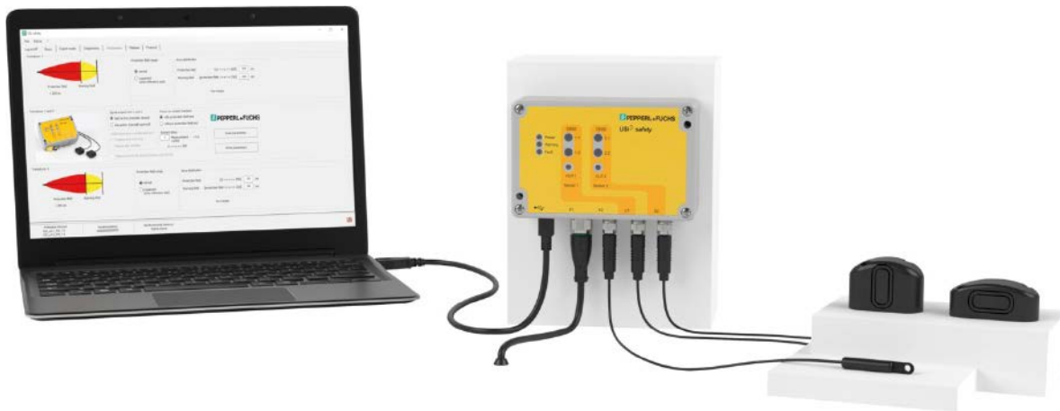
Das Ultraschallsensorsystem USi-safety besteht aus einer Auswerteeinheit, ein oder zwei Sensoreinheiten, einem Temperatursensor und einer Software. Es bietet zwei unabhängige Kanäle, die jeweils die ISO 13849 Kategorie 3 PL d erfüllen.
