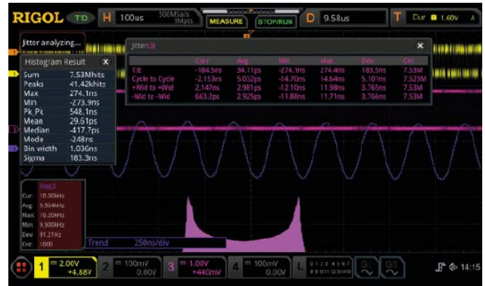
Abb. 2: Jitter-Messung des Taktsignals mit Histogramm- und Trenddarstellung
