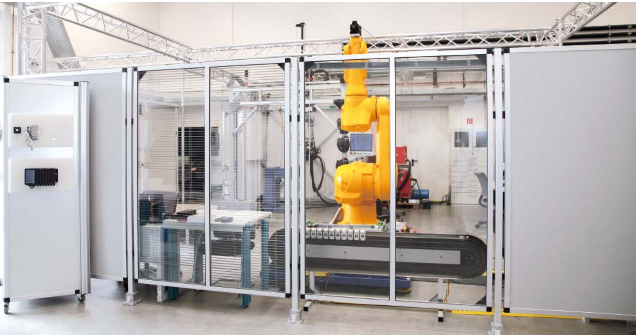
Das gesamte Robotics Lab ist mit blickdichten Trennwänden sowie Sichtfenstern aus Verbundsicherheitsglas von RK Rose+Krieger von der Laborhalle abgetrennt.
