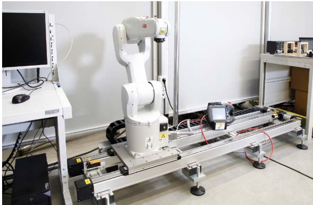
Ein Roboter des Typs IRB1200 von ABB wurde auf den RK DuoLine-Linearachsen von RK Rose+Krieger montiert, wodurch der Aktionsradius des Roboters deutlich erweitert wurde.
