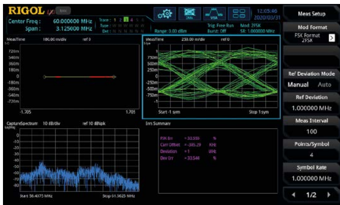
Abb. 3: Vermessung des Augendiagramms eines verrauschten Datensignals sowie dessen Auswirkung auf die HF-Übertragung und BER
