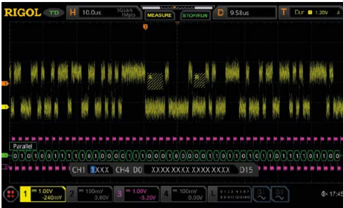
Abb. 1: Datensignal (gelb) mit Takt (lila) und Decodierung, stabilisiert mit Duration-Trigger
