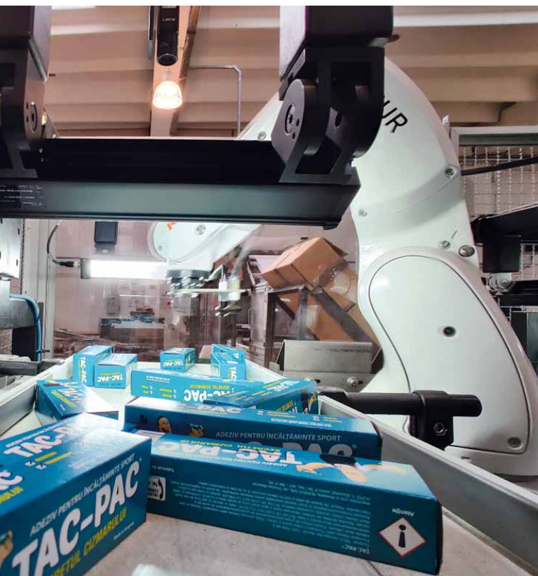
Sobald das Produkt in den Arbeitsbereich des zweiten Roboters gelangt, wird es erneut lokalisiert, die Barcodes werden überprüft und bei Übereinstimmung in die Blisterverpackung eingelegt.
