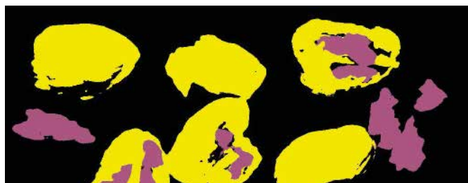
Durch die Auswertung der Hyperspektralbilder können Nusschalen oder andere Fremdkörper eindeutig identifiziert werden.
