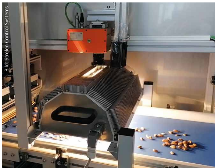
Das unsortierte Schüttgut wird unter einer FX10-Hyperspektralkamera von Specim und einer Beleuchtung hindurch transportiert und dabei aufgenommen.
