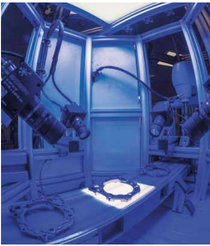
Fünf hochauflösende Kameras prüfen die Teile auf dem laufenden Förderband in Auf- und Durchlicht auf viele Merkmale. Die kürzere Wellenlänge der großflächigen blauen LED-Beleuchtung erhöht die Detektionspräzision.
