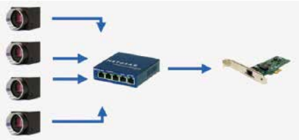
Eine Variante eines Multikamera-Setups: Mehrere BFS-PGE-Kameras sind an einen Gigabit-Ethernet-Hub angeschlossen, der wiederum an einen Gigabit-Host-Adapter angeschlossen wird.
