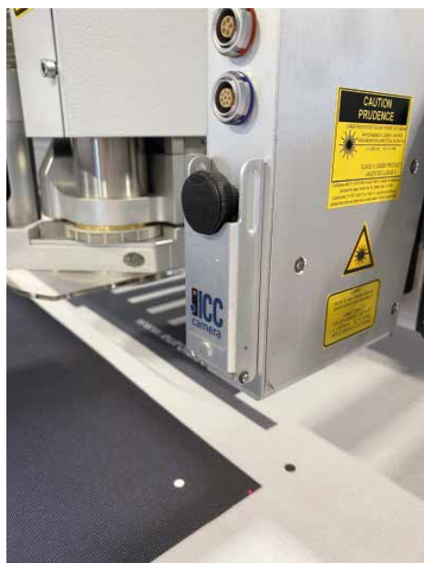
Eine CCD-Kamera erfasst die tatsächliche Lage von Passermarken und gleicht die Ergebnisse mit den vorgegebenen Druckdaten ab.
