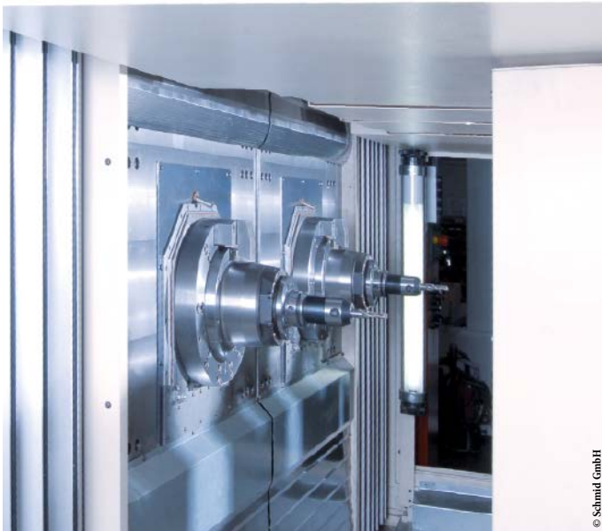
Im vertikalen Werkzeug-Magazin des doppelspindigen Bearbeitungszentrums von Schmid Maschinenbau sorgt ein Vierpunktlager von Rodriguez für die Drehung.
