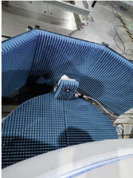
Das Zielpositionierungssystem erlaubt einen Bewegungswinkel von \pm 55^\circ von der zentralen Position vor dem VUT.
