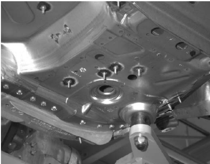
Aus deren jeweiliger Position bestimmt die Software des Bildverarbeitungssystems auf wenige Zehntel Millimeter genau die tatsächliche Ist-Position der Karosse und berechnet den Bahnvektor, um den die programmierte Roboterbewegung korrigiert wird.
