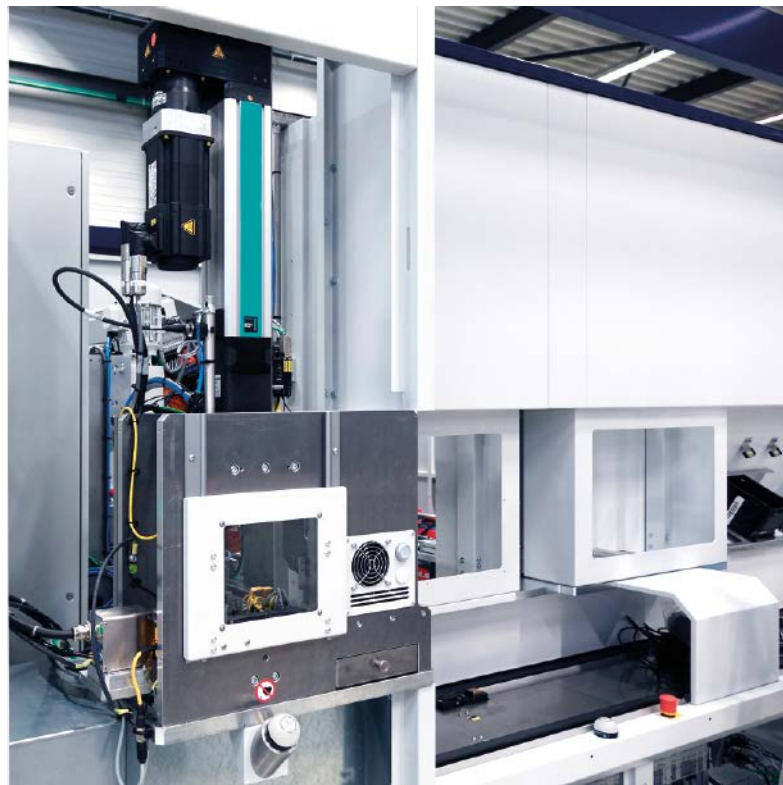
In der Fertigungslinie von Pierburg sind sowohl das pneumohydraulische Tox-Kraftpaket als auch der elektromechanische Antrieb Tox-ElectricDrive verbaut.
