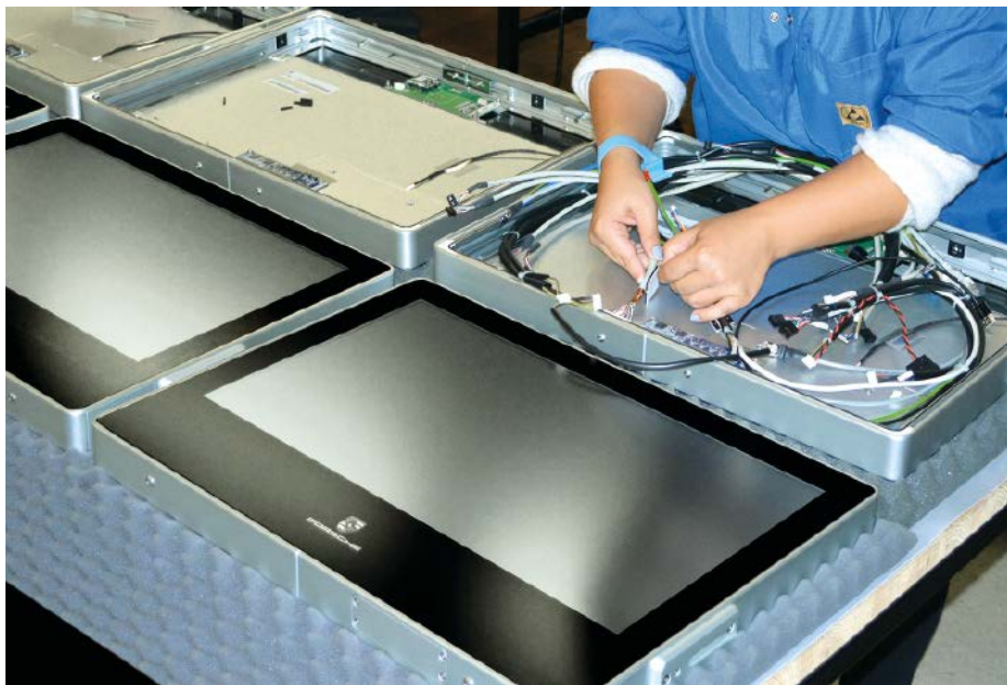
Die Montage und Verdrahtung der Panel-PCs geschieht manuell, denn dabei ist Genauigkeit nötig.
