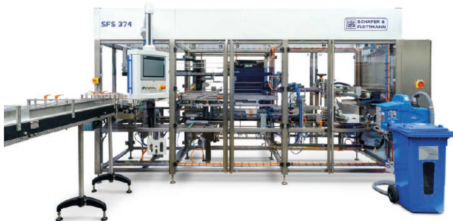
Die Wrap-around-Anlage SFS 374 verpackt 250 Butterstücke in der Minute.
