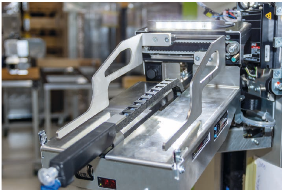
Das Greifersystem ist mit einer kleinen Kette der Serie E065 von Igus ausgestattet. Mitgeführt wird auch eine Vakuundleitung für das Ansaugen der zu kommissionierenden Packung.
