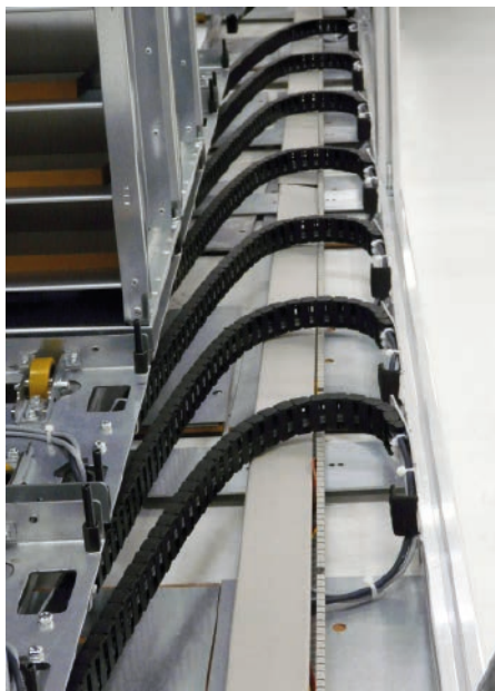
Jeder Schubschrank erhält seine Energie- und Signalversorgung über eine Energiekette der Baureihe E065 und Chainflex-Leitungen.
