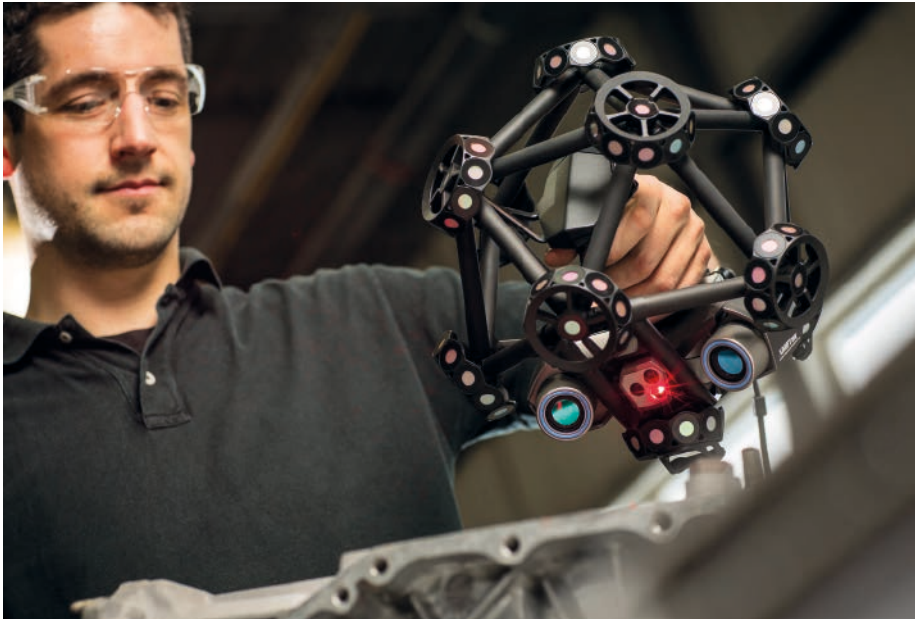
Alternative zur CMM: MetraScan 3D bei der Inspektion eines Automobilteils
