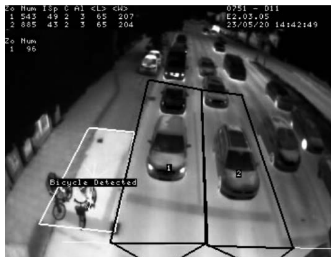
Mit den Wärmebildsensoren von Flir kann zwischen PKW, LKW und Fahrrädern unterschieden werden.
