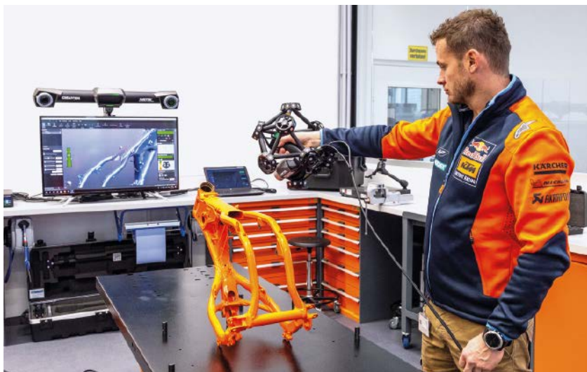
Mit dem 3D-Scanner lässt sich der Rahmen des Sportmotorrades schnell auf Fertigungsfehler oder Abweichungen während des Rennstreckeneinsatzes prüfen.
