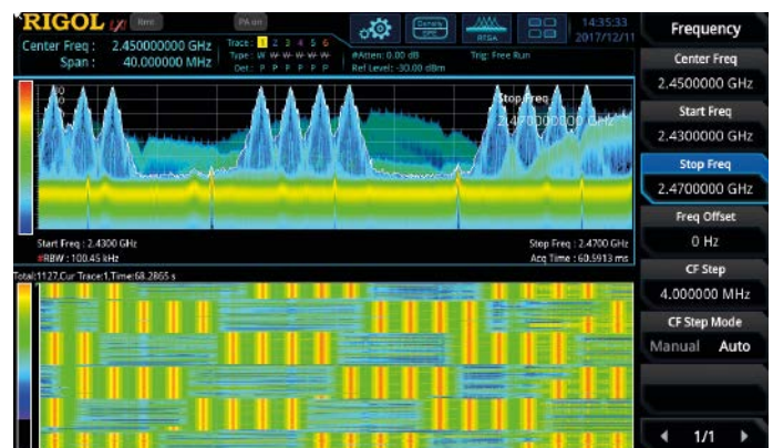
Abb. 2: Echtzeitmessung im ISM-Band 2.4 GHz (Dichtedarstellung in Kombination mit Wasserfalldarstellung)
