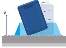
Hoher Schwerpunkt, hohe Beschleunigung: Fördergut kippt
