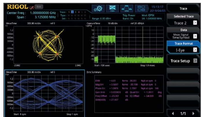
Abb. 3: Digitale Demodulation eines QPSK modulierten Signals mit kleineren Störungen
