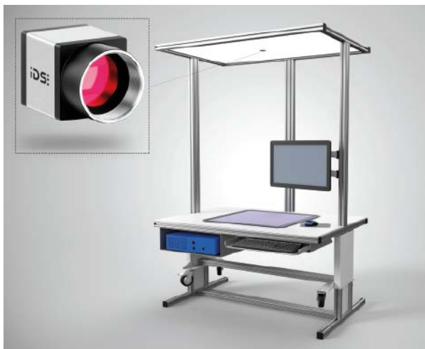
Das Montageassistenzsystem „Der Schlaue Klaus“ mit USB3-uEye CP-Industriekamera von IDS
