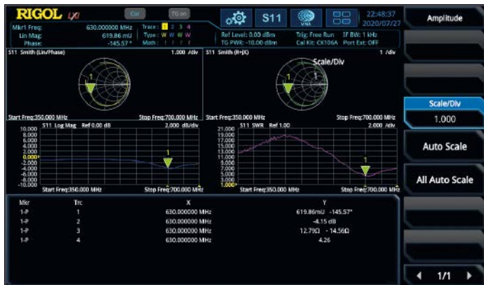
Abb. 5: VNA-Mode mit der S11-Parameter-Darstellung wie Smith und Polarebene, Rückflussdämpfung in [dB] und SWR
