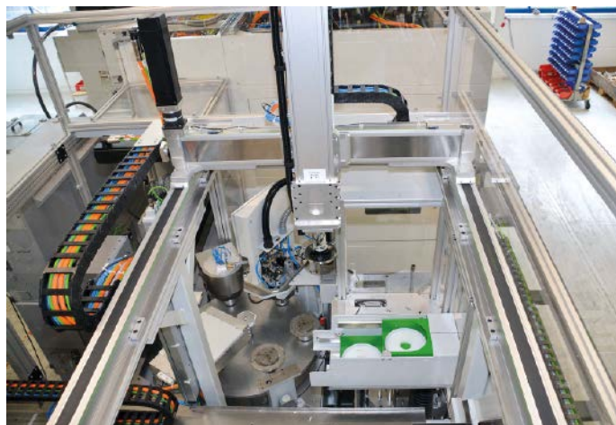
Ein kartesisches Dreiachssystem von Hiwin ist Dreh- und Angelpunkt der Automatisierungslösung. Da es im Vergleich zu einem Roboter weniger wiegt, konnte das Portal platzsparend oberhalb des Drehtisches angeordnet werden.
