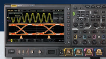
MSO8000 UltraVision II Speicheroszilloskop Bis 2 GHz Bandbreite, 500 Mpkt. Speichertiefe, 10 GS/sek. Echtzeitabtastrate
