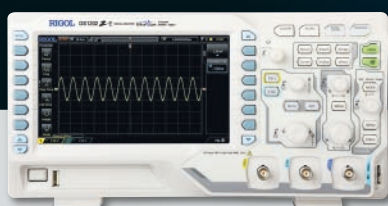
DS1202Z-E UltraVision Speicheroszilloskop 200 MHz Bandbreite, max. 24 Mpkt. Speichertiefe, 1 GS/sek. Echtzeitabtastrate
