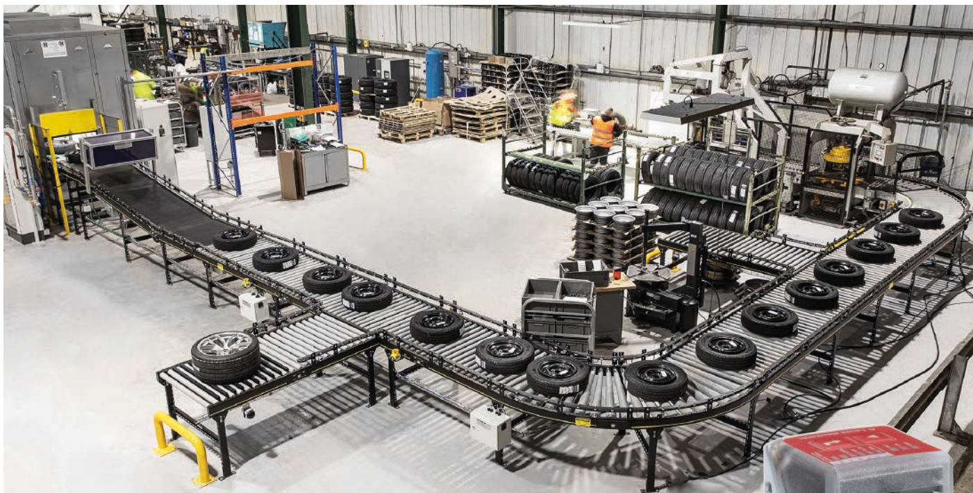
Automatisierte Förderanwendung bei Tyre-Line – von der Baugruppenidentifikation bis hin zur Reifenbefüllung
