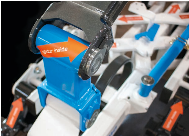
Insgesamt 14 Iglidur-G-Gleitlager kommen pro Hackelement in der Höhenführung zum Einsatz.
