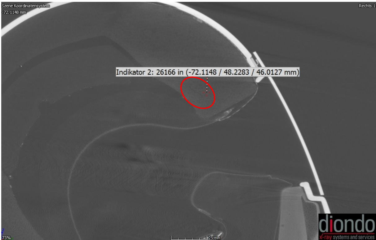
Abbildung 15: innenliegender Riss (rot umkreist) der Helm-Innenschale im Stirnbereich, CT-Schnittansicht entlang der y-Achse (von rechts nach links); mit freundlicher Genehmigung der Fa. diondo GmbH
