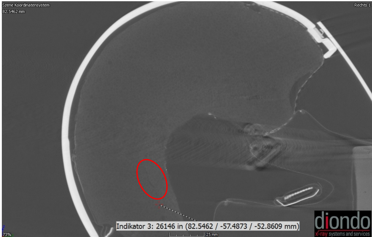
Abbildung 16: innenliegender Riss (rot umkreist) der Helm-Innenschale im rechten Nackenbereich, CT-Schnittansicht entlang der y-Achse (von rechts nach links); mit freundlicher Genehmigung der Fa. diondo GmbH
