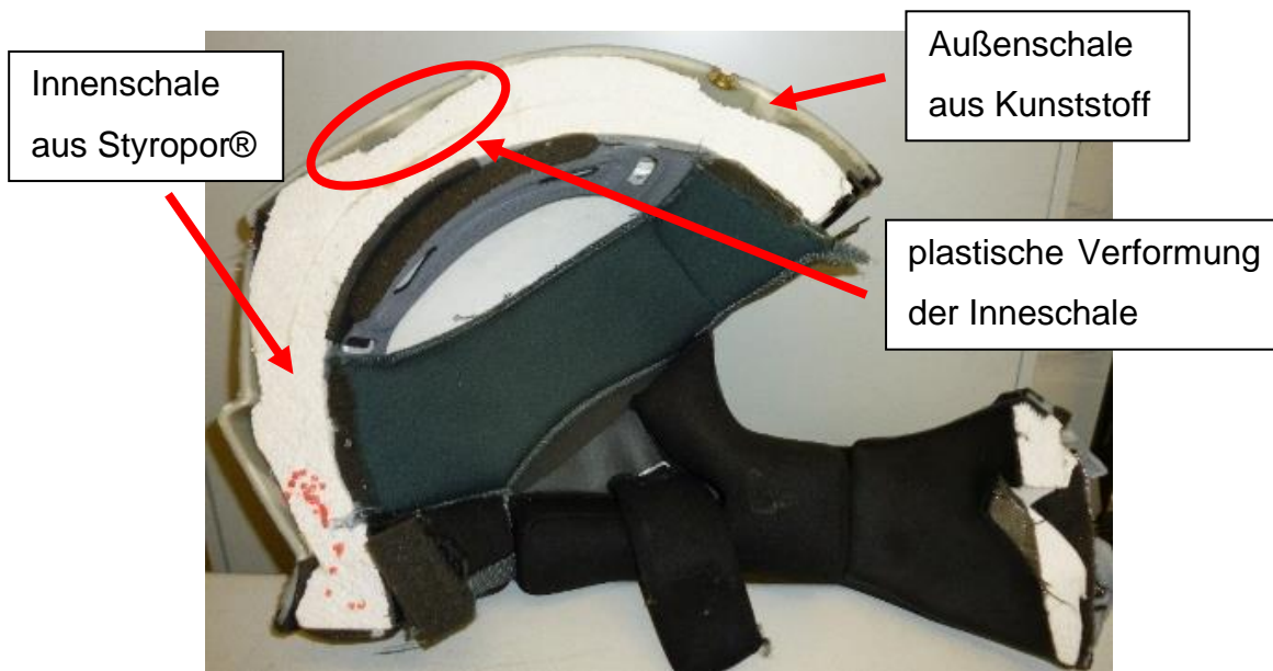
Abbildung 1: Aufgeschnittener Helm nach der Prüfung nach ECE-R 22, mit freundlicher Genehmigung des TÜV Rheinland in Köln, Peter Schaudt [3]
