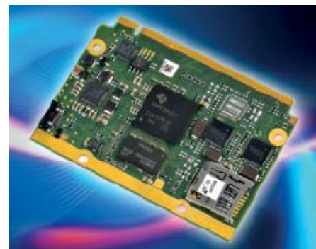
Die Modulfamilie MSC nanoRISC mit ARM-Prozessor (AM335x) für unterschiedliche Performance-Klassen
