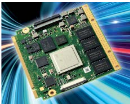
Das skalierbare Qseven-Modul MSC Q7-IMX6 auf Basis des ARM-Prozessors i.MX6 mit Cortex-A9 RISC-CPU
