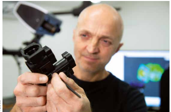
Frank Fynbo begutachtet das Gehäuse einer Wasserpumpe. Ob alle Maße stimmen, kann er aber nur nach der Prüfung mit dem 3D-Sensor entscheiden.
