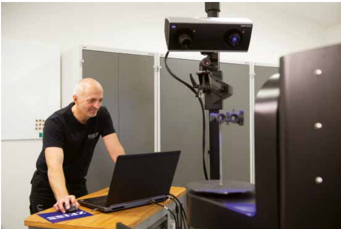
Frank Fynbo am Zeiss Comet. Die Einrichtung des 3D-Scanners und die Messung dauern nur wenige Minuten.
