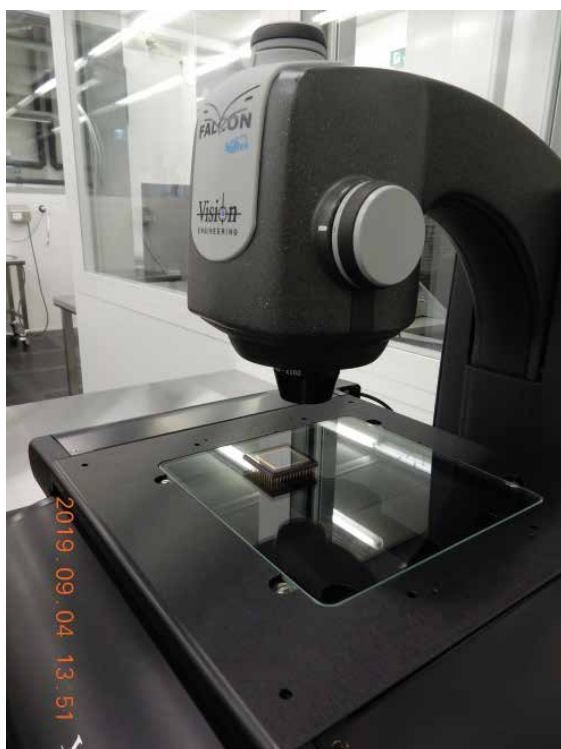
Mithilfe des Falcon-CNC-Messmikroskops von Vision Engineering werden die Kamerasensoren des am MPS entwickelten Instruments für den UV-Bereich vermessen.
