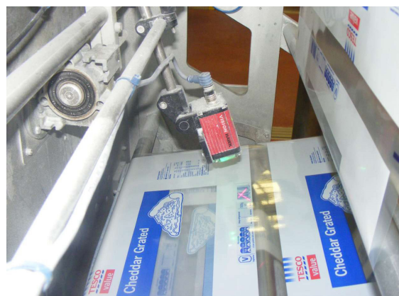
Abbildung 15: Unter rauen Produktionsbedingungen kann es während der Herstellung zu Beschädigungen an hochwertigen Etiketten kommen, daher müssen die Etiketten unbedingt ein weiteres Mal überprüft werden, nachdem sie Produktionsphasen durchlaufen haben, in denen eine hohe Beschädigungswahrscheinlichkeit besteht.
