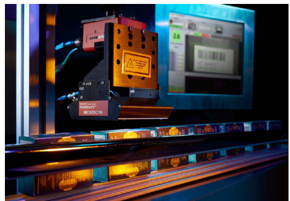
Abbildung 6: Ein in der Verpackungsstraße installiertes Überprüfungssystem erfasst mit einer speziellen Kamera- und Beleuchtungskonfiguration Bilder der Etiketten, deren Druckqualität dann durch eine industrielle Bildverarbeitungs-Kontrollsoftware gemäß ISO/IEC-Standards überprüft wird.
