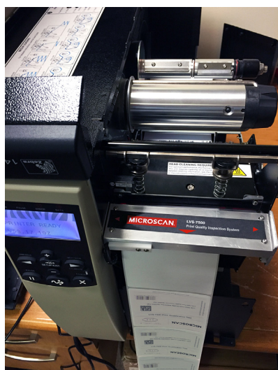
Abbildung 13: Ein Inline-Überprüfungssystem wurde direkt an einem Zebra®-Drucker angebracht, um die Korrektheit der Etikettierung während des Druckvorgangs zu überwachen.
