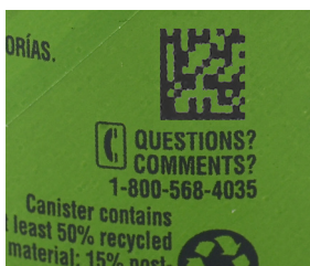
Abbildung 10: Während der optischen Gestaltung des Etiketts wurde der ursprüngliche DataMatrix-Code gestreckt und leicht vergrößert. Diese Änderungen können Lesbarkeits- und Konformitätsprobleme im Produktionsprozess verursachen.
