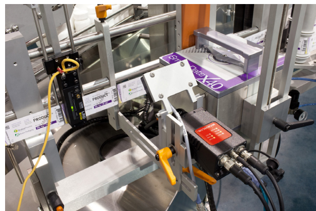
Abbildung 14: Um die Qualität der Etiketten zu gewährleisten, können Überprüfungs-schritte an jedem Ort der Fertigungsstraße hinzugefügt werden, an dem möglicherweise Fehler entstehen und ein Überprüfungssystem zur Senkung der Kosten beiträgt.
