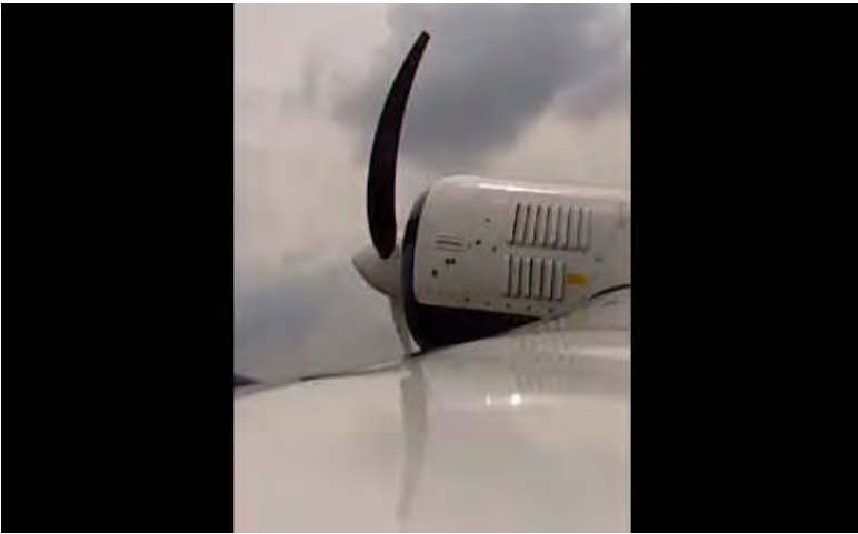
Der Rolling Shutter-Effekt: Die Verzerrung entsteht durch die Bewegung des Propellers während der Belichtung der einzelnen Zeilen.
