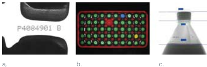
Abbildung 2 - Machine Vision-Anwendungen wie z.B. das Lesen von Prüfcodes (a), das Erkennen von Verpackungsinhalt (b) und das Überprüfen der Füllhöhe bei Flaschen (c) stellen unterschiedliche Anforderungen an die Bildaufnahme, Beleuchtung und Software.
