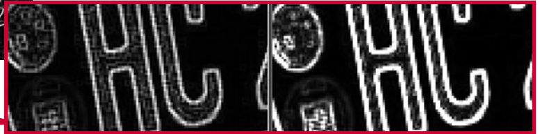
Abb. 2: Graustufenbild, dilatiertes Graustufenbild (oben) und Ergebnis der Differenzbildung (links unten); zum Vergleich rechts unten Ergebnis einer Sobel-Filterung mit Detailausschnitt aus den Kantenbildern
