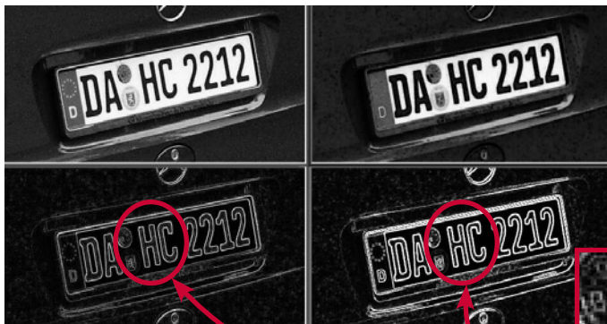
Abb. 2: Graustufenbild, dilatiertes Graustufenbild (oben) und Ergebnis der Differenzbildung (links unten); zum Vergleich rechts unten Ergebnis einer Sobel-Filterung mit Detailausschnitt aus den Kantenbildern
