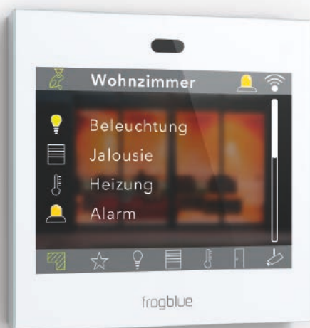
Das Frog-Display: ein kompakter Touchscreen für die Steuerung zu Hause oder von unterwegs
