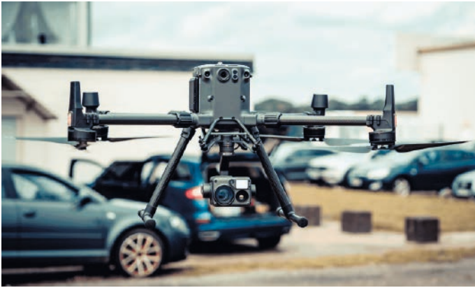
GPS-gestützte Bestandsaufnahme per Video-Drohne ermöglicht zentimetergenaue Vorvermessung von bis zu 20 Trassen-Kilometern pro Tag.
