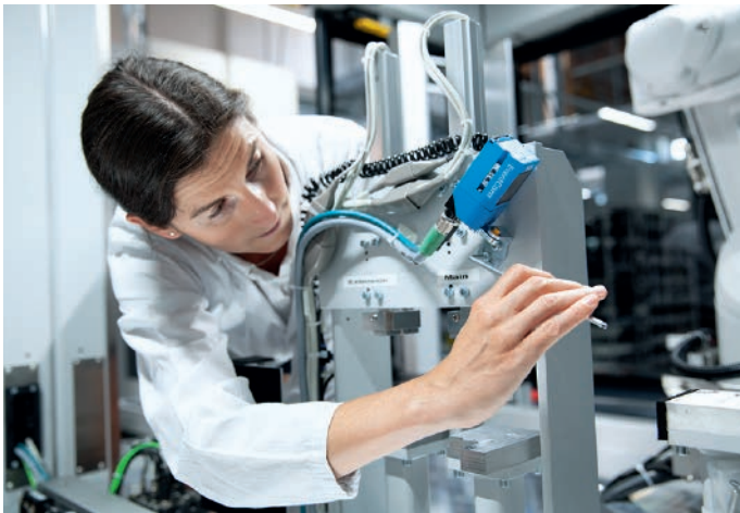
Aufgrund ihres geringen Gewichtes, der kompakten Bauform, der vielseitigen Befestigungsoptionen am Gehäuse und des optionalen Montagezubehörs kann die EventCam sehr vielseitig ein- und umgesetzt werden.
