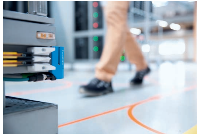
Wird der ungeplante Stopp eines FTS während der Transportfahrt durch eine Person ausgelöst, wird dies von der EventCam zuverlässig erkannt.
