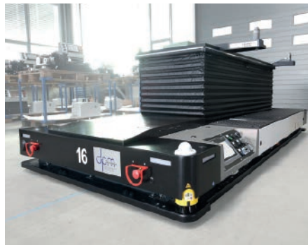
Bei der Kommunikation mit FTS-Flotten bringt der besonders energiearme Betrieb Vorteile. Im Ruhezustand befinden sich die FTS im Sleep-Modus, aus dem sie per Funk bei sehr kurzer Latenzzeit „aufgeweckt“ werden.
