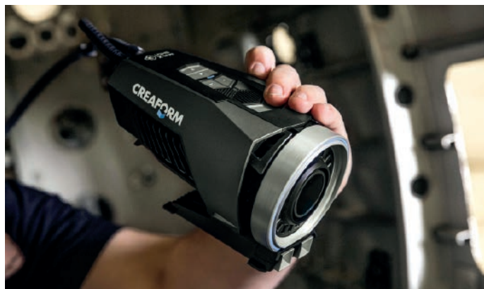
Fotogrammetriekamera MaxShot 3D zum Messen großer Objekte mit hoher Genauigkeit
