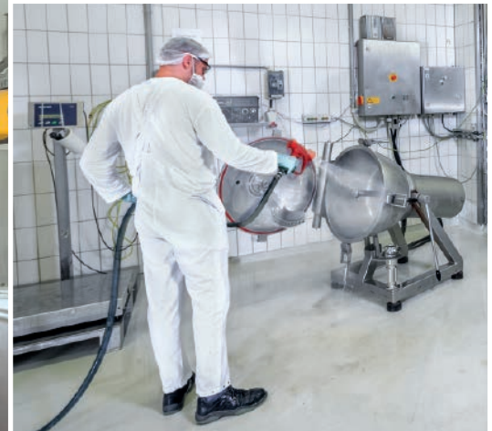
Mit Wasser, Reinigungssubstanzen und Desinfektionsmitteln reinigen die Mitarbeiter täglich die Produktionsanlagen.
