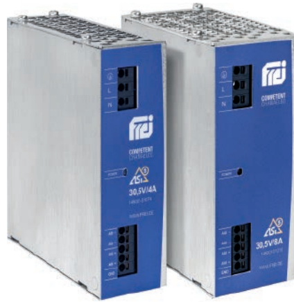
Die neuen Primärschaltregler haben sowohl Filter für ASI-5 als auch für ASI-3, sind also abwärtskompatibel; am Ausgang stellen sie je nach Ausführung 0...8 A beziehungsweise 0...4 A zur Verfügung.
