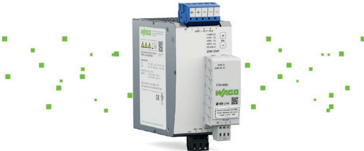
Die Wago-Stromversorgung Pro 2 kann über ein Kommunikationsmodul (aktuell IO-Link, später auch Ethernet-basierende Protokolle wie MQTT, Ethernet IP, Profinet) mit der SPS oder einem IoT-Gateway verbunden werden.
