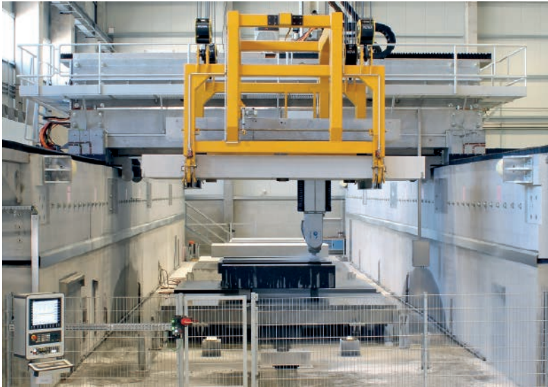
In einer hochpräzisen Reitz-Maschine zur Produktion von Maschinenkomponenten aus Granit sorgen Amo-Messgeräte für die erforderliche Genauigkeit.
