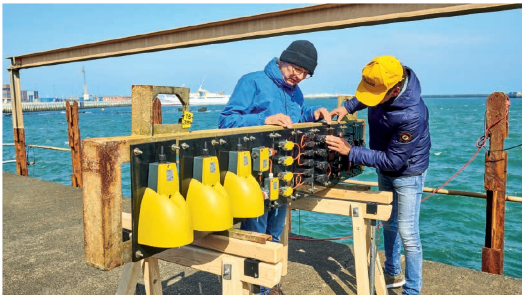
Zwischenfazit: Produkte aus dem Steute-Extreme-Programm werden nach sechs Monaten an der Mole auf Helgoland einer „Halbzeit“-Bestandsaufnahme unterzogen.
