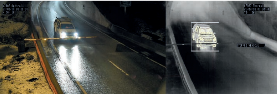
Erkennung haltender Fahrzeuge am Tunnelausgang mit Dual-AID-Kameras der Flir-ITS-Serie
